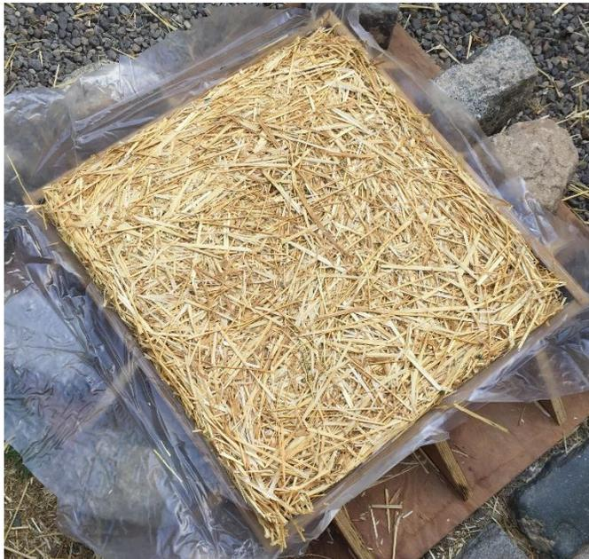
Figura 3-11: Aislante de paja de trigo, prueba n°1.
