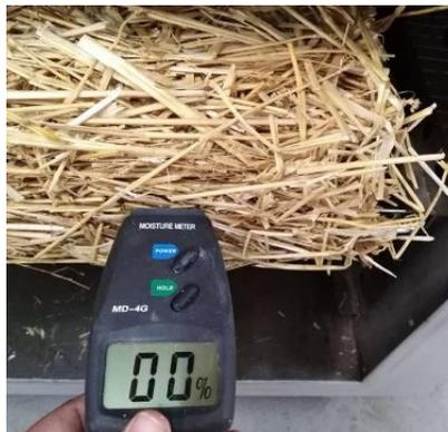
Figura 3-15: Humedad relativa pasado 5 horas en horno de viento a 50°C.
