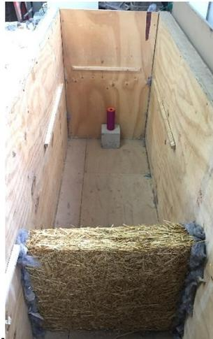
Figura 4-1: Elemento tipo "A" de 100mm, en ensayo acústico.
