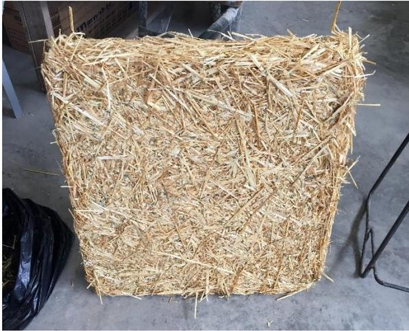
Figura 3-16: Aislante tipo "A" 100mm (70/30%).
