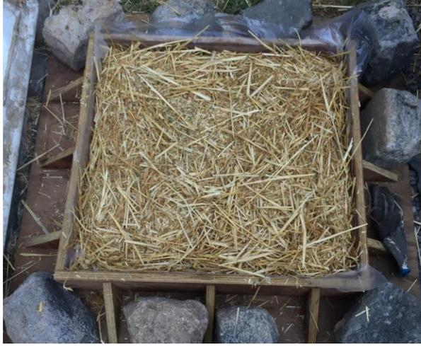
Figura 3-10: Paja mezclada incorporada en el molde compactador.
