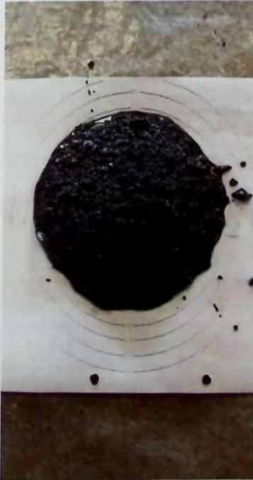
*Figura 6.6 Rango 2-3 adecuada para la elección del agua de premezclado utilizando escoria de cobre"*
