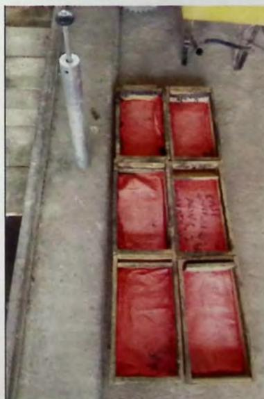
*Figura 7.2 "Molde utilizados para ensayo modificado"*
