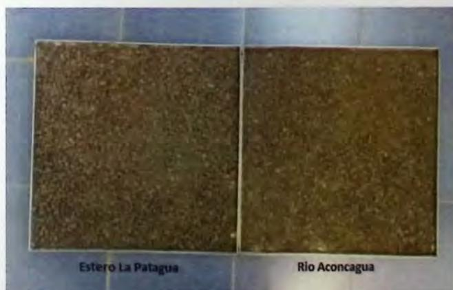
Figura 7.1 "Dosificación del agregado homogeneizado utilizando escoria de cobre reproducida"
