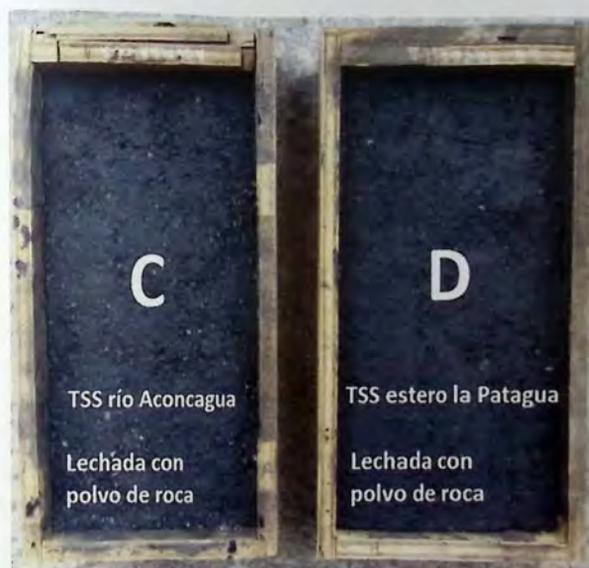
Figura 7.6 "Cape seal (C) y (D) (TSS en escoria de cobre(A)y(B) y lechada asfáltica utilizando polvo de roca).
