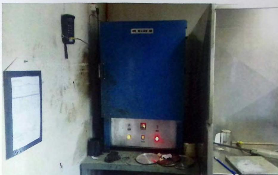
*Figura A7 "Horno para acondicionamiento de Muestras"*
