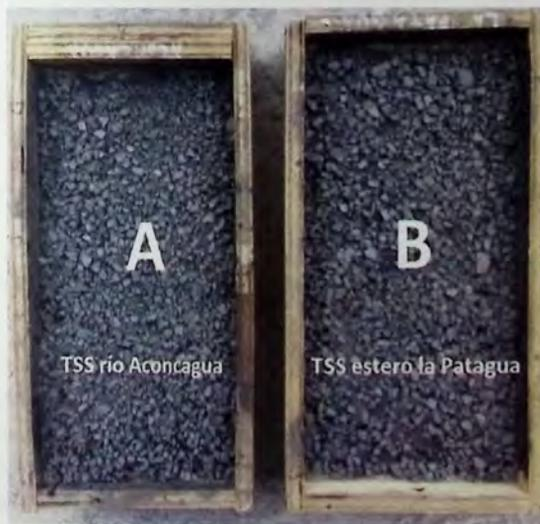
Figura 7.5 "TSS, reproducido (A) río Aconcagua y (B) estero la Patagua, utilizando escoria de cobre"
