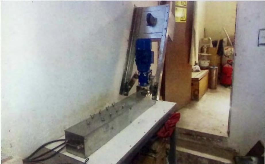
*Figura A6 "Maquina de Rueda Cargada para diseño de lechadas asfálticas"*
