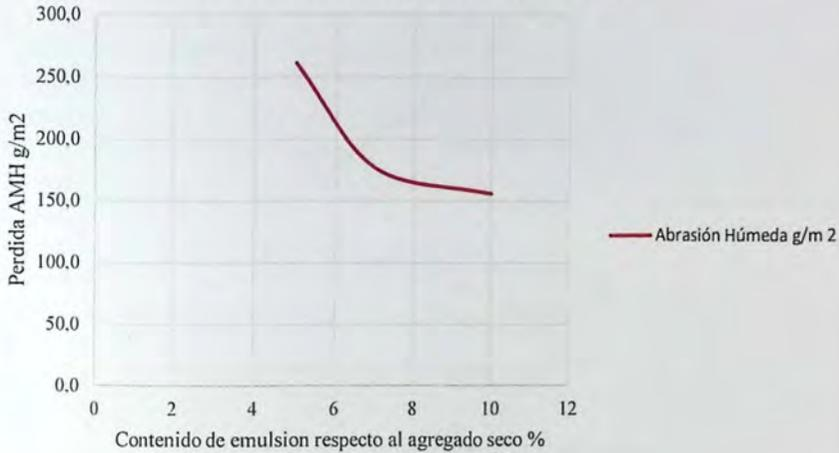
*Figura 6.7 "Abrasión en medio húmedo para la escoria de cobre"*
