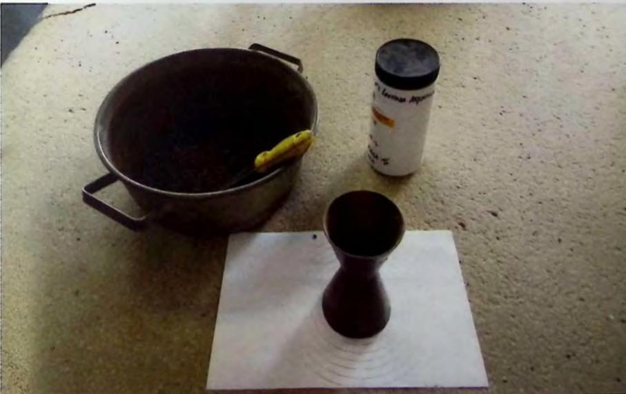
*Figura A4 "Ensayo de consistencia de lechadas asfálticas"*
