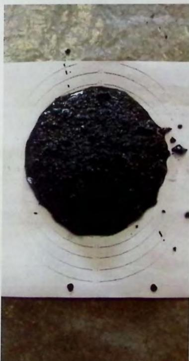
Figura 6.2 "Rango 2-3 adecuada para la elección del agua de premezclado utilizando polvo de roca"
