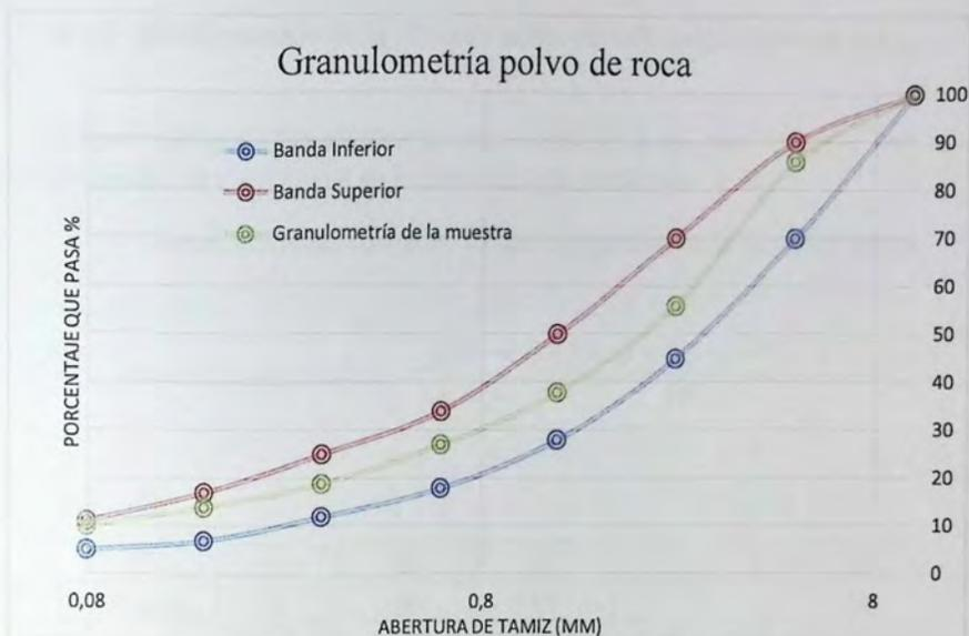
Figura 6.1 "Granulometría del polvo de roca para Lechada Asfáltica"
