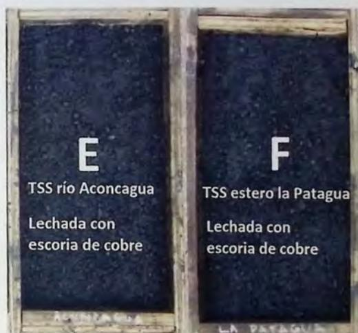
Figura 7.7 "Cape seal (TSS y lechada asfáltica ambos reproducidos con escoria de cobre)"
