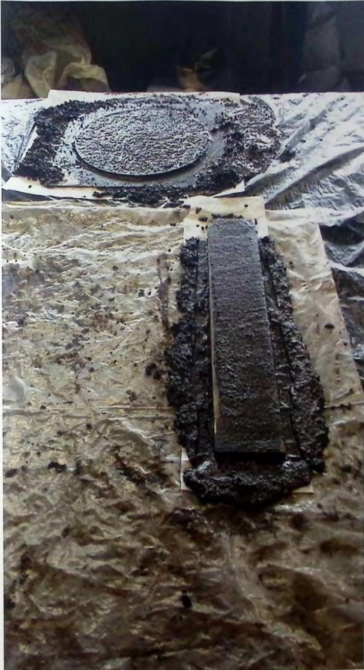
*Figura A9 "Construcción de probetas de AMH y Rueda de Carga"*
