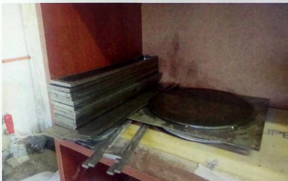
*Figura A8 "Moldes para construcción de probetas de AMH y Rueda de Carga"*
