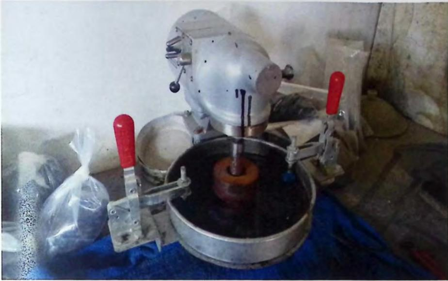
*Figura A5 "Maquina de abrasión en medio húmedo para diseño de lechadas asfálticas"*
