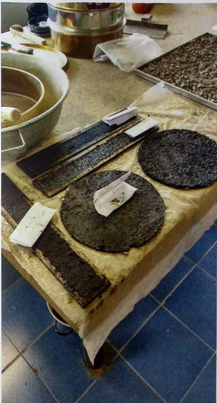
*Figura A10 "Probetas de AMH y Rueda de Carga"*
