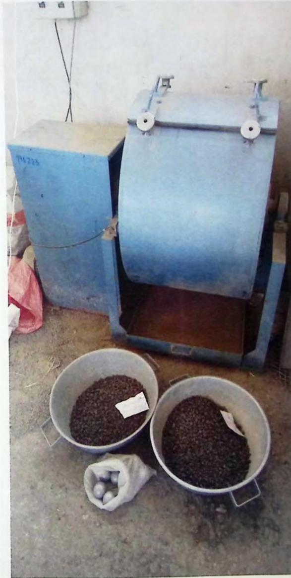
*Figura A11 "Máquina de Desgaste de los Ángeles para ensayo de desgaste y chancado del material"*
