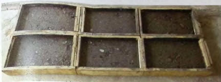
*Figura 7.3 "Moldes con base granular estabilizada, compactada para TSS y Cape Seal"*
