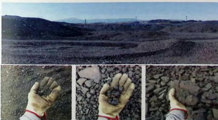
Figura 5.3 "Condición de la escoria de cobre en el patio de acopio CODELCO Ventanas"
