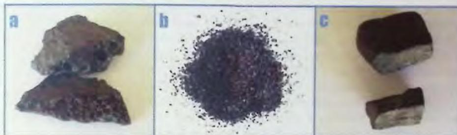
Figura 2.6 "Tipos de escoria según grado de enfriamiento (Expandida – Granallada – Botadero)"
