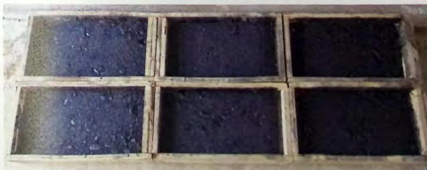
*Figura 7.4 "Probetas de base estabilizada compactada, sobre ésta la emulsión imprimante"*
