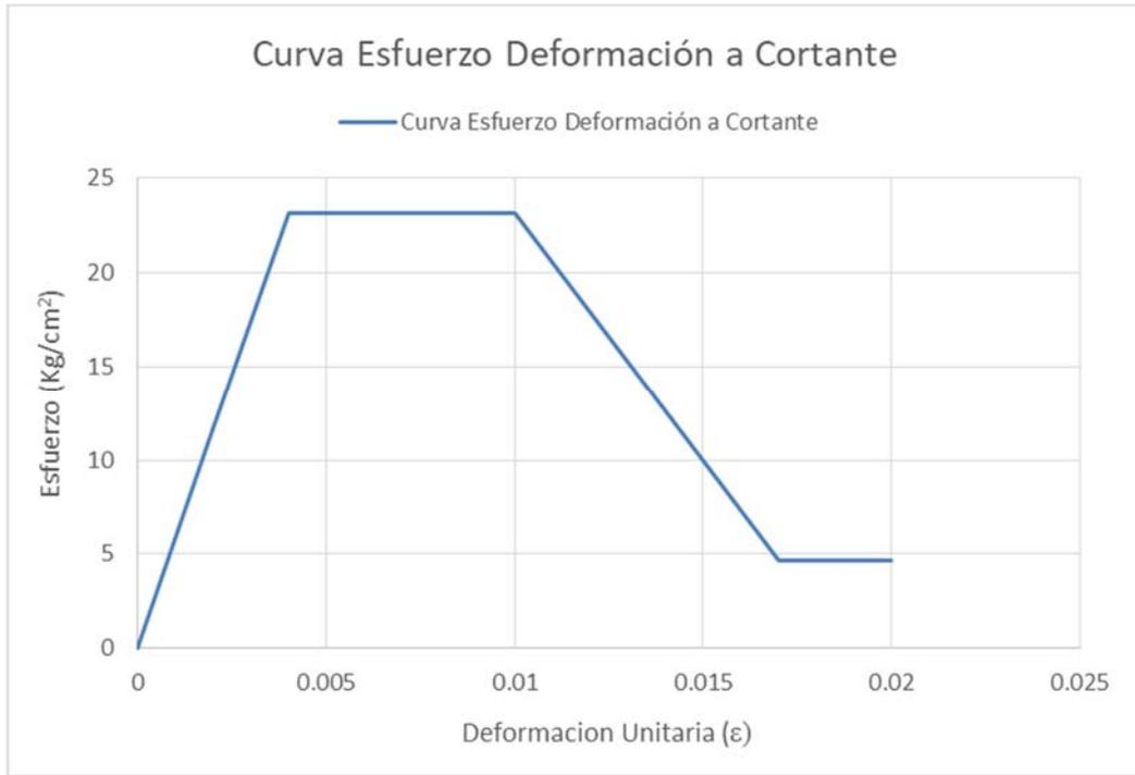
Figura 4.6 - Curva normalizada esfuerzo- deformación a corte para  $h_w/l_w \leq 1.5$  (Fuente: Propia)
