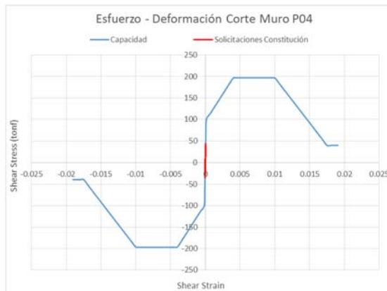
Figura 7.10 - Demanda de corte muro P04 registro de Constitución. (Fuente: Propia)
