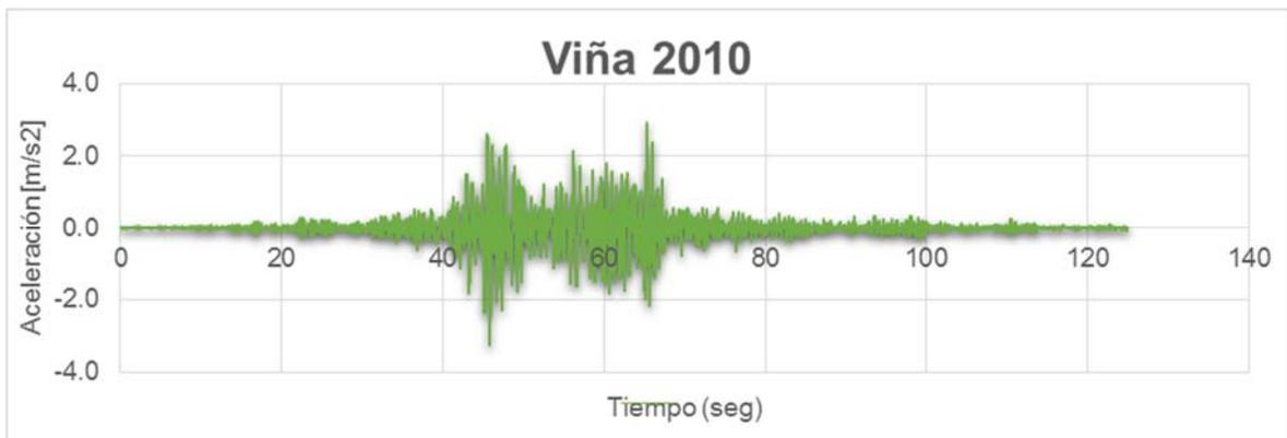
Figura 4.30 - Registro de aceleración ciudad de Viña del Mar, componente E-W.
