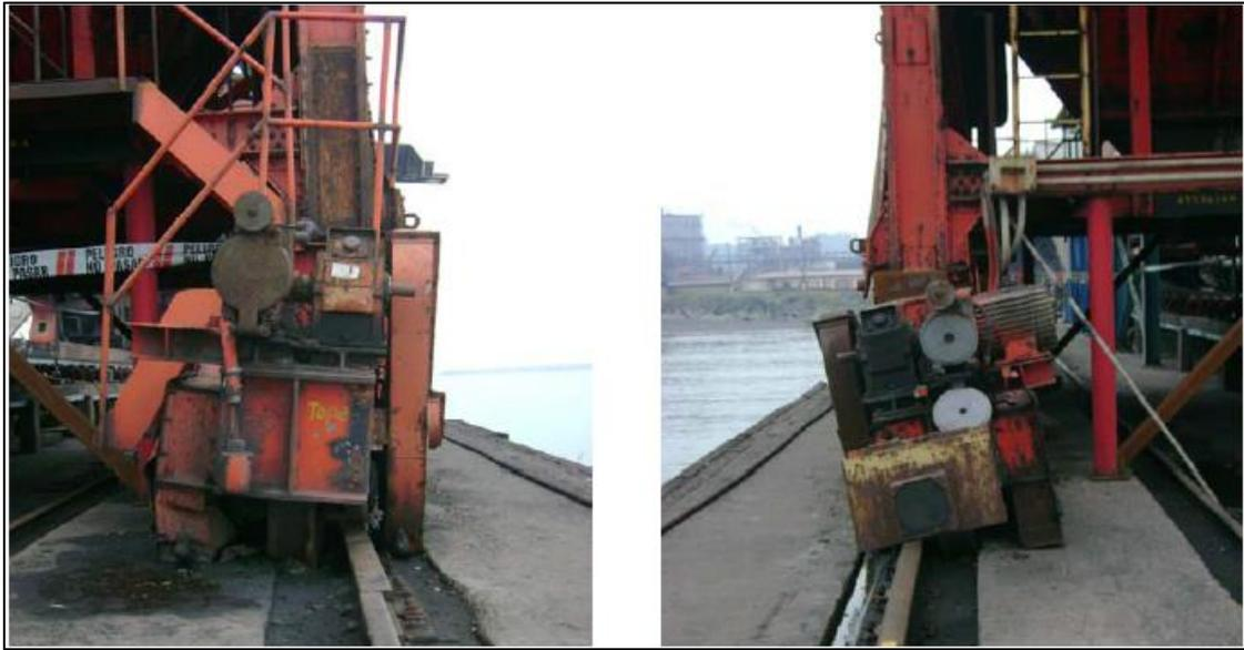
**Figura D.34: Bogies descarrilados.**
