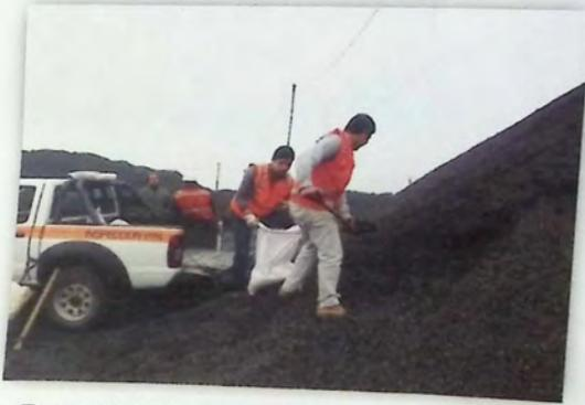
*Figura 10.2: Muestreo aleatorio de escoria de cobre.*
