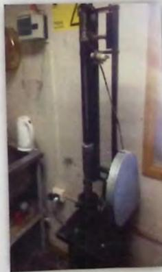
*Figura 10.9: compactador Marshall.*
