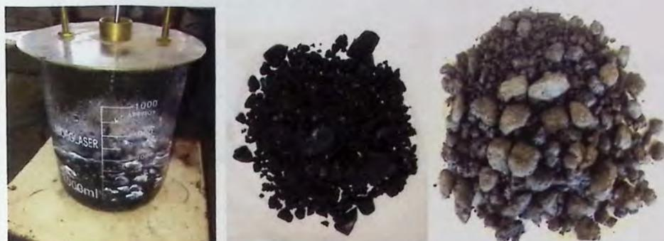
Figura 4.1: Método del Hervido, resultados para escoria de cobre (1) y árido del río Aconcagua (2).
