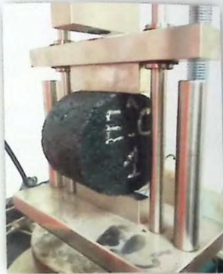
Figura 10.13: Probeta ensayada a compresión diametral RTI.
