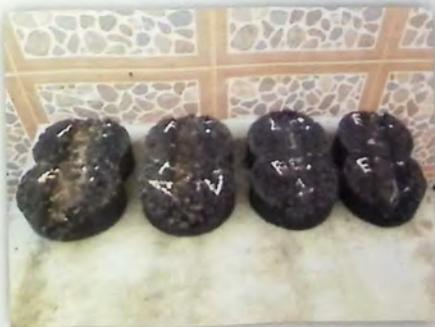
Figura 10.15: Probetas Superpave después de ensaye de ahuellamiento.
