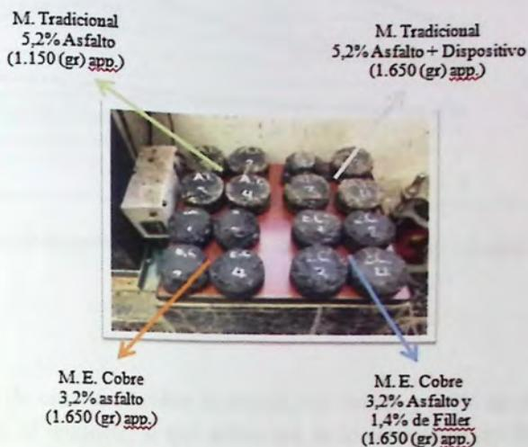
Figura 5.11: Probetas después del ensaye de Cantabro.
