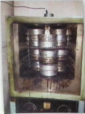
*Figura 10.6: Agregados pétreos a temperatura de 154°C +/- 3°C.*
