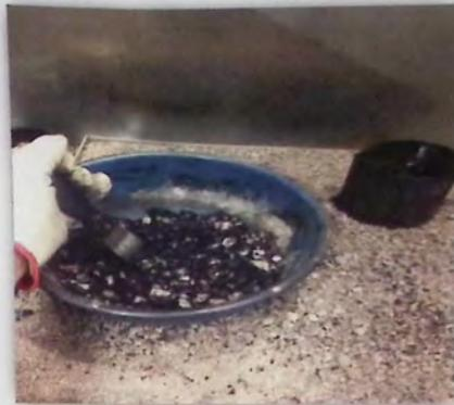
*Figura 10.7: Mezclado de agregados con ligante asfáltico.*
