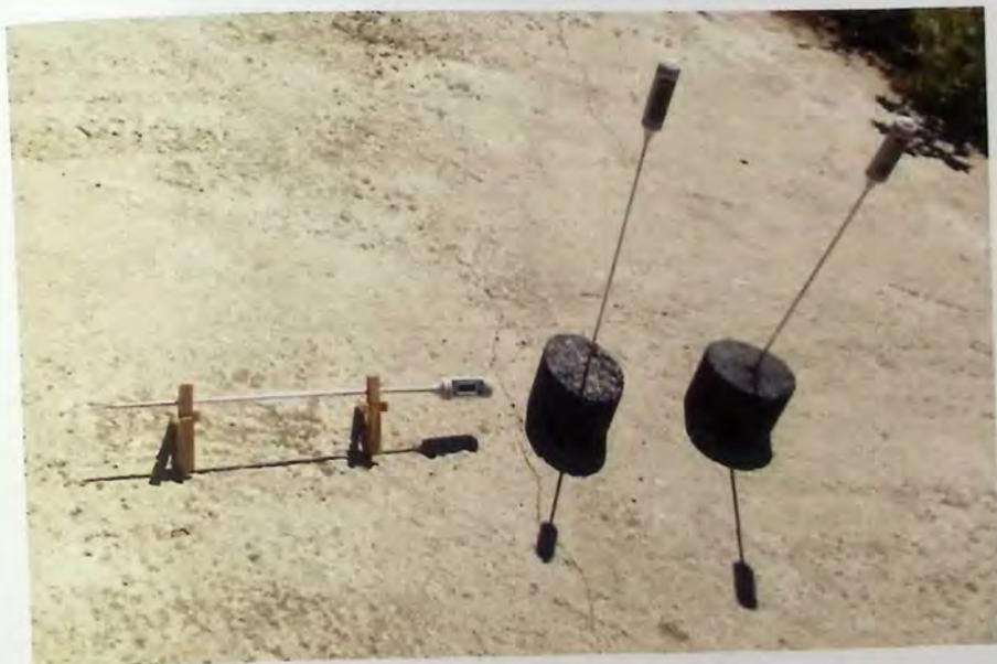
Figura 5.1: Registro de temperaturas para mezclas asfálticas bajo radiación solar.
