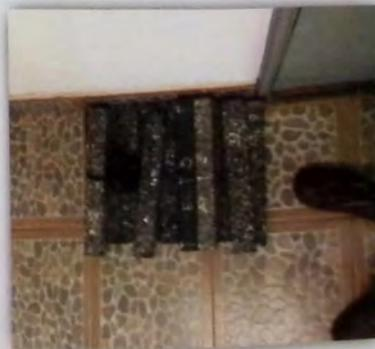
Figura 10.16: Vigas para ensaye de fatiga.
