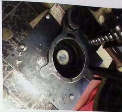
Figura 5.9: Confección de probeta con dispositivo de plomo
