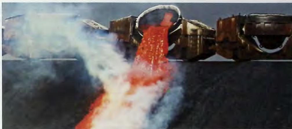
*Figura 1.1: Depósito de escoria de cobre. Fuente: Pool (2011).*
