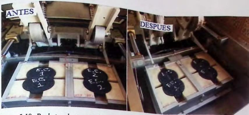
Figura 5.18: Probetas de escoria de cobre antes y después del ensayo de Ahuellamiento
