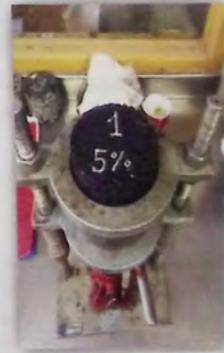
*Figura 10.10: Desmolde de probetas.*
