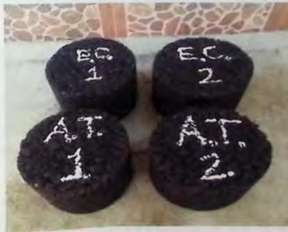
Figura 5.17: probetas SUPERPAVE para ensayo de ahuellamiento.
