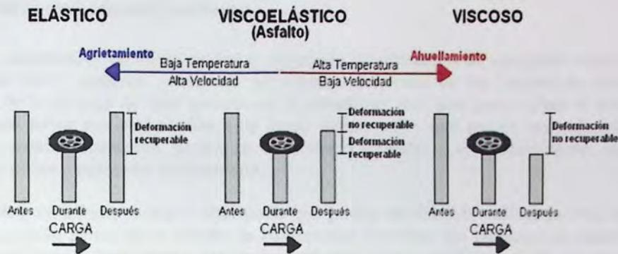
Figura 1.3: Comportamiento de un pavimento flexible
