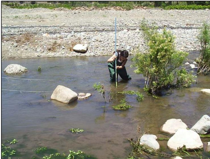
**Figura N° 37:** Medición de profundidad del pozón
