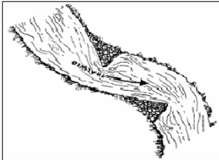
**Figura N°9:** Detalle de un deflector en posición alternada.
