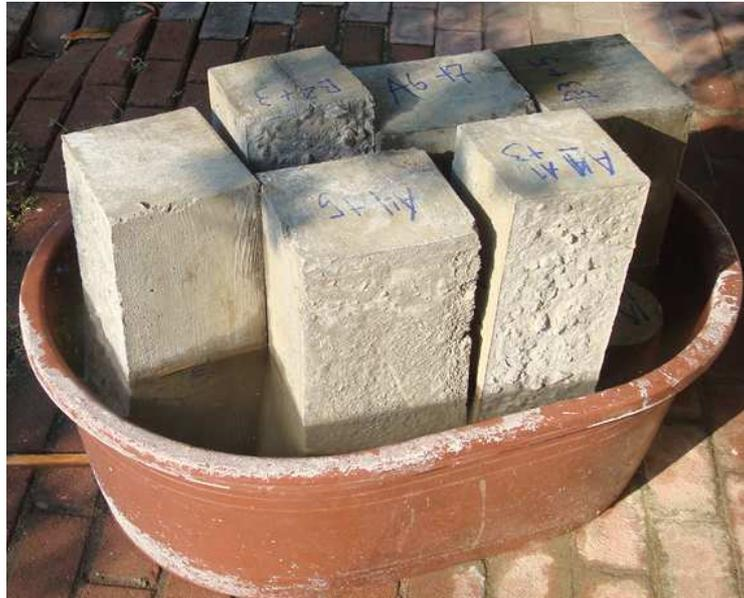
Figura 24: Vigas de hormigón sumergidas parcialmente.
