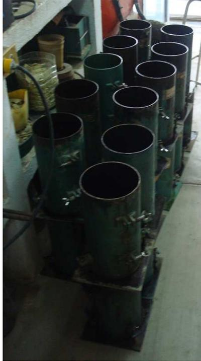
**Figura 20: Recipientes para cilindros de hormigón.**
