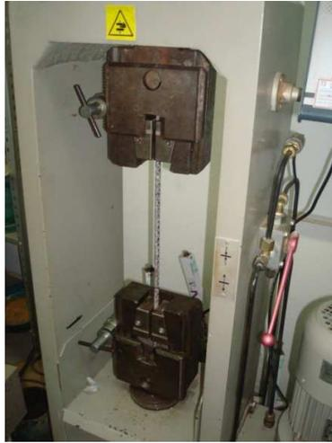
**Figura 26: Barra de acero sometida a tracción sujeta por mandíbulas de acero.
