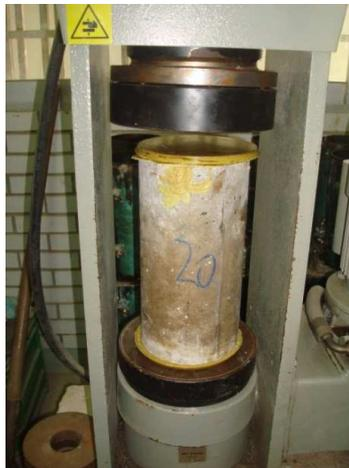
Figura 25: Cilindro cabeceado en equipo a compresión.
