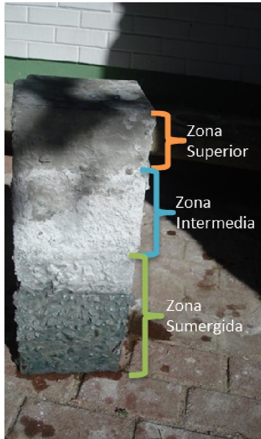
**Figura 30: Zonas distinguibles en vigas de hormigón.**
