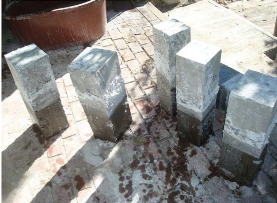
Figura 29: Vigas de hormigón a los 14 días de exposición.
