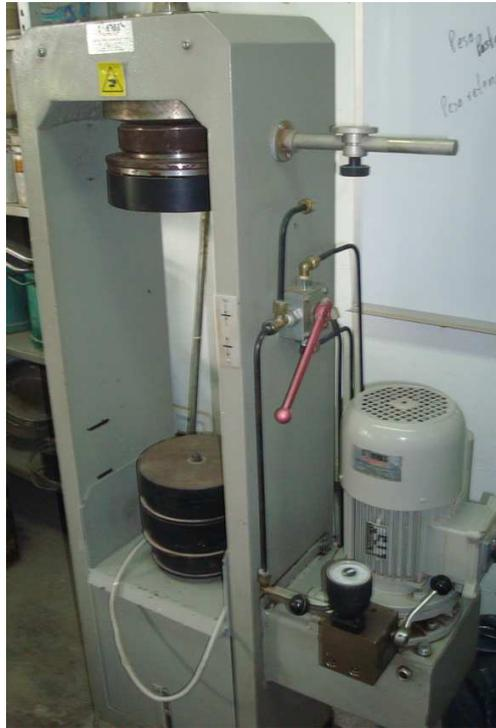
Figura 19: Máquina de ensayo de tracción.
