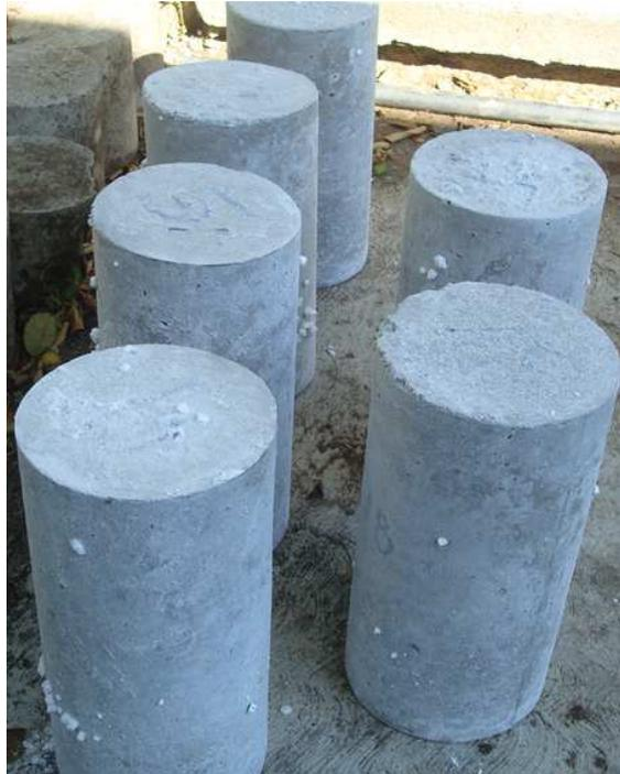
**Figura 28: Presencia de cristales de Na<sub>2</sub>SO<sub>4</sub> en cilindros.**
