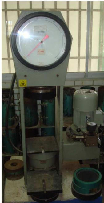
Figura 18: Máquina de ensayo de compresión.
