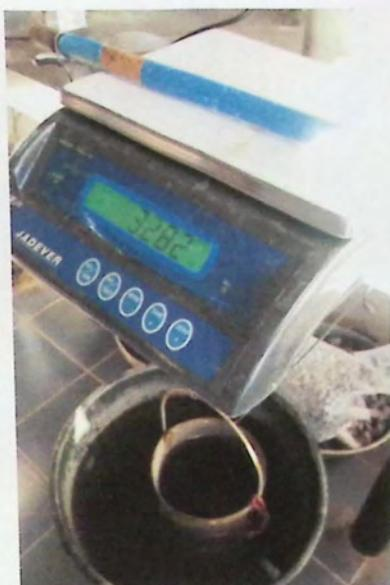
*Imagen N°7.7 - Sumergimiento para obtener densidad real seca*
