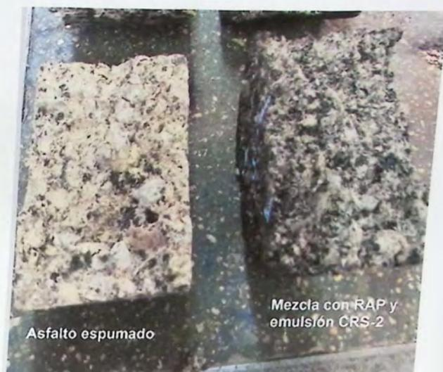
*Imagen N°7.26 - Diferencia entre asfalto espumado y mezcla con CRS-2*
