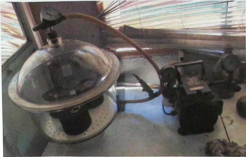
*Imagen N°7.16 - Bomba desecadora al vacío para estabilidad saturada*
