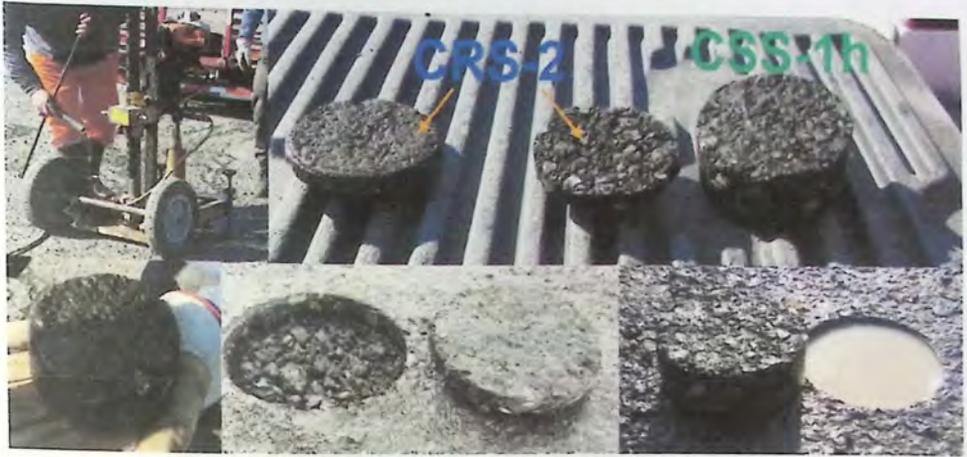
Figura N°5.4 - Testigos de Primera prueba realizada luego de 2 semanas
