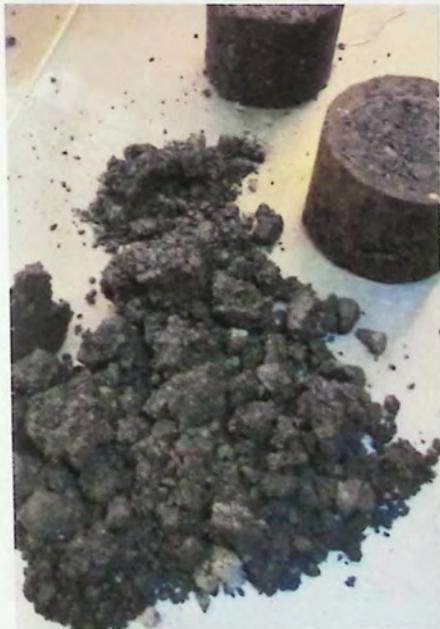
*Imagen N°7.17 - Probeta disgregada luego de extraerla de la piscina a 60°C*
