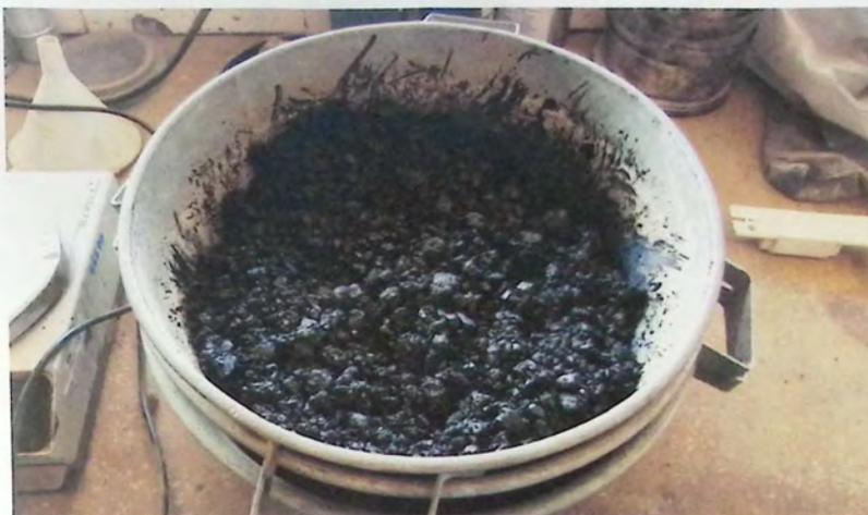
*Imagen N°7.5 - Primera mezcla con RAP y emulsión CRS-2.*
