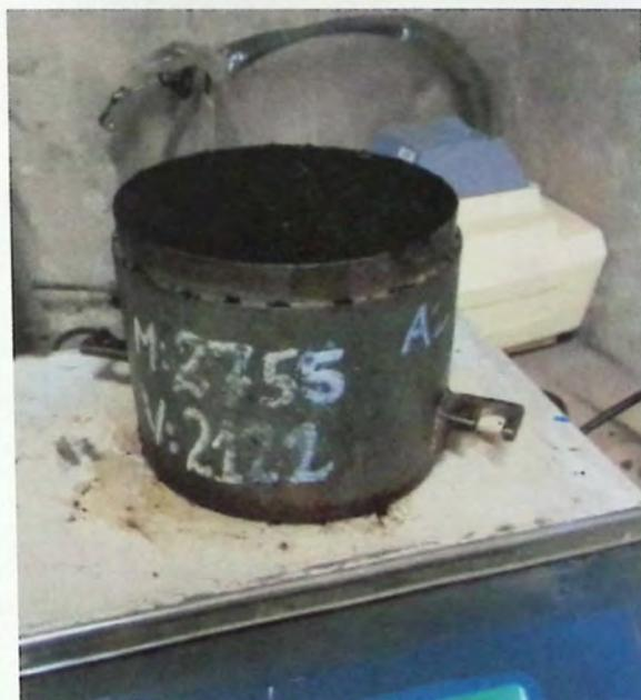
*Imagen N°7.6 - Probeta Proctor*
