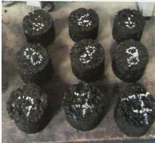
*Imagen N°7.23 - Probetas con 100% de RAP y emulsión CQS*
