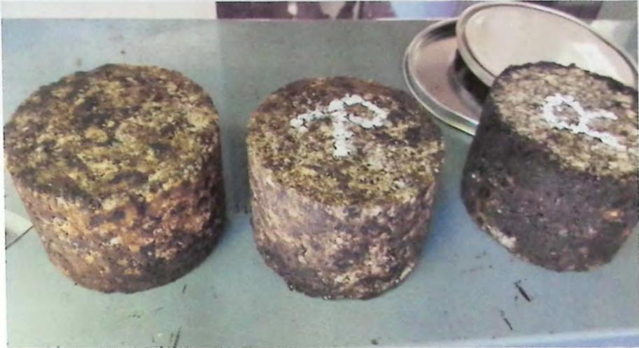
*Imagen N°7.12 - Probetas de RAP con agregado de polvo de roca y emulsión CRS-2*
