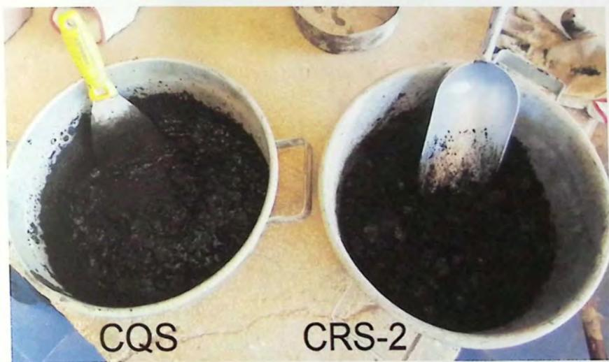
*Imagen N°7.21- Mezcla con CQS y CRS-2*
