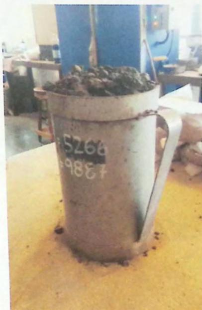
*Imagen N°7.8 - Recipiente metálico para densidad aparente suelta*
