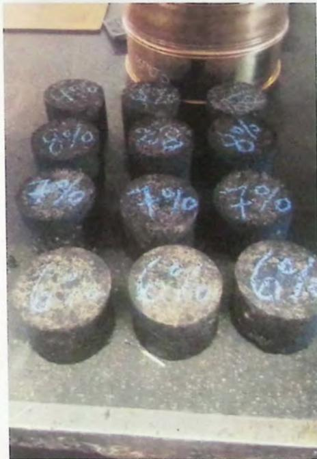
*imagen N°7.13 - Probetas para estabilidad seca y saturada con emulsión CRS-2*
