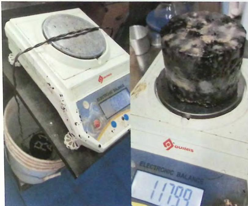
*Imagen N°7.11 - Sumergimiento de probeta para densidad real de mezcla asfáltica*
