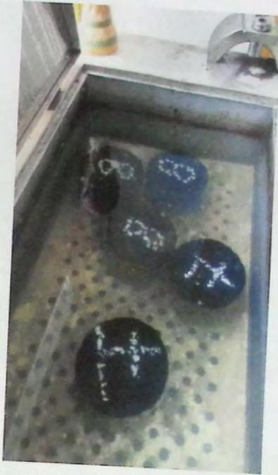
Imagen N°7.24 - Probetas CQS sumergidas a 60°C
