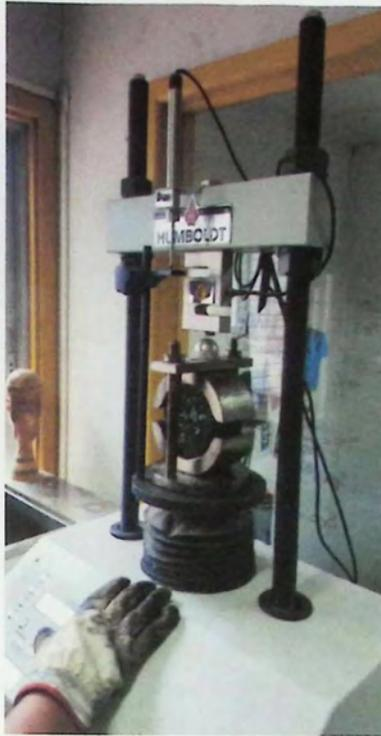
*Imagen N°7.22 - Estabilidad Marshall para mezcla con el uso de emulsión CQS*
