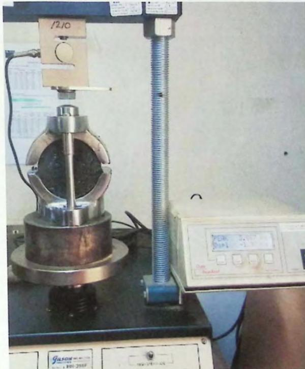
*Imagen N°7.19 - Estabilidad Marshall para probeta CSS-1h*
