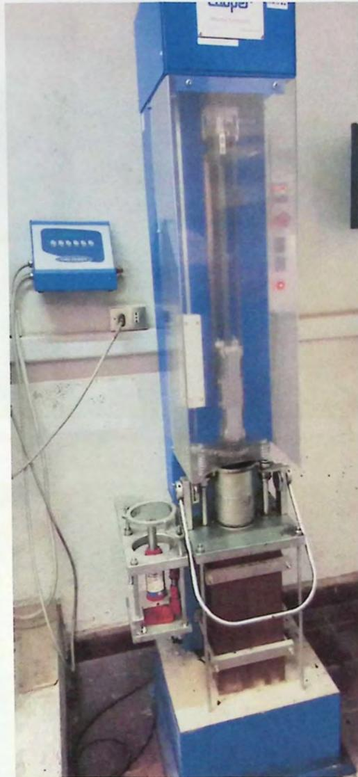
*Imagen N°7.9 - Máquina compactadora de probetas Marshall*
