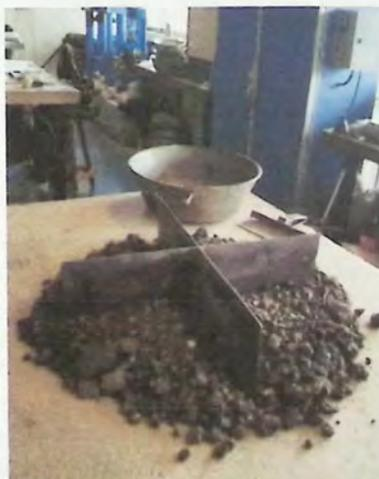
Figura Nº4.2 - Segundo cuarteo de muestra de fresado obtenido de la Ruta E-57 (Los Andes), para determinar granulometría y posterior contenido de asfalto en la muestra
