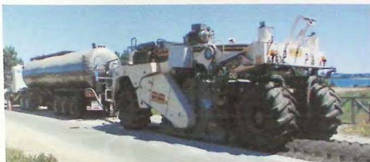
*Figura N°2.6 – Máquina Recicladora asfáltica para bases estabilizadas*
