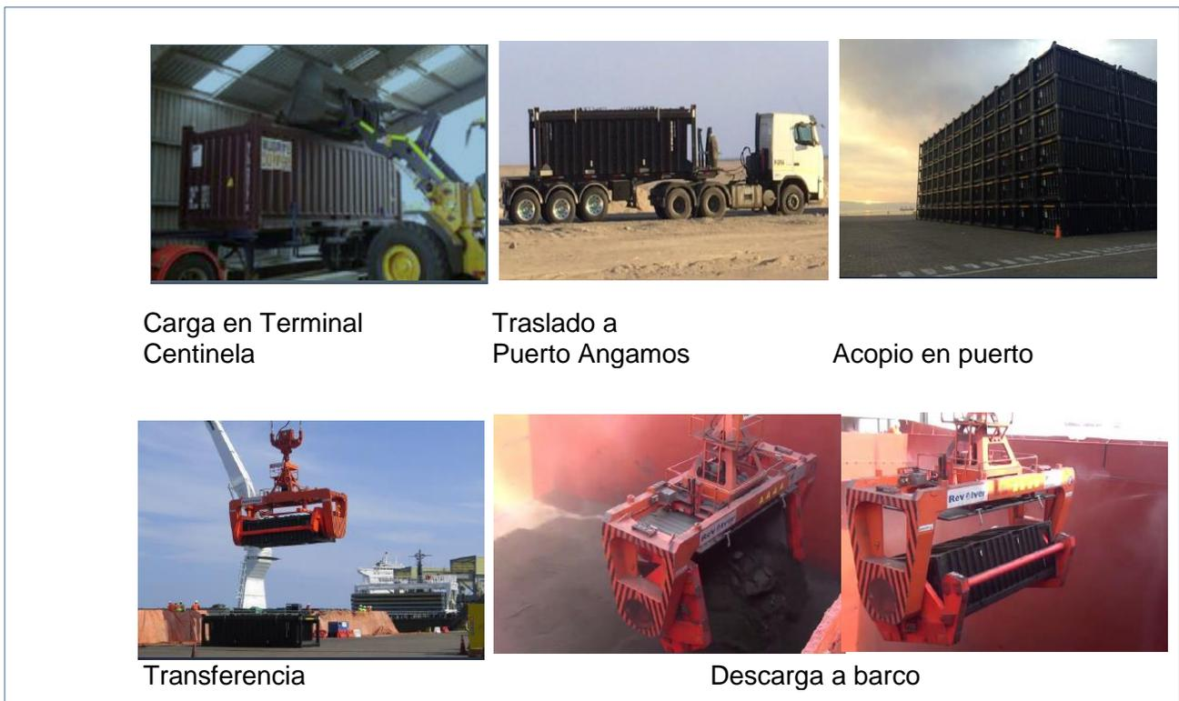
**FIGURA N° 12: Esquema de operación de los contenedores volteables**
