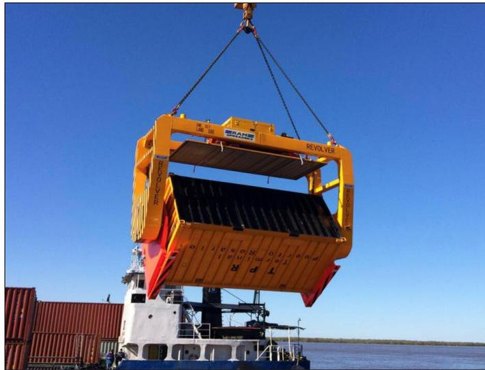
**FIGURA N° 11: Contenedor volteable y reach stacker que retira su tapa y lo voltea.**
