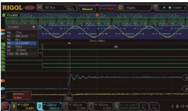
Figura 3. bus de entrada y salida del DAC de 8 bits ampliado. Uso del cursor para el tiempo de subida.
