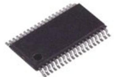
Figura 3: El controlador CFP de dos canales intercalados STNRGPx2 de STMicroelectronics. (Fuente: STMicroelectronics).
