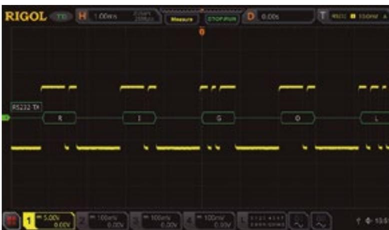
Figura 7. Configuración para supervisar los datos decodificados en un bus RS232.
