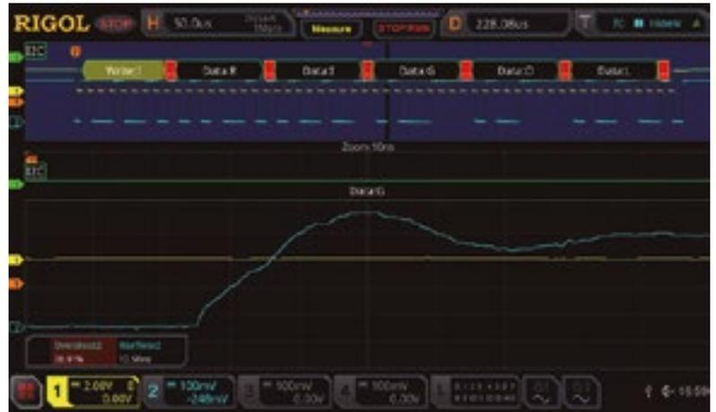
Figura 8. Señal I2C ampliada para medir el tiempo de subida y el análisis del jitter.
