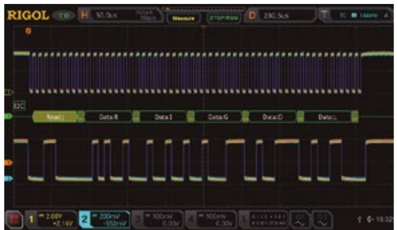
Figura 5. Medición de un bus I2C con una buena conexión al muelle de tierra de la sonda.
