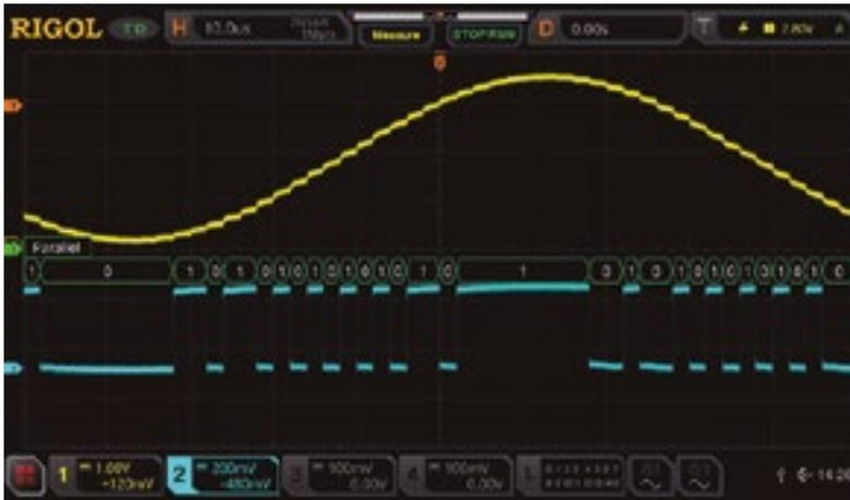
Figura 1. Salida del DAC y un bit de entrada.
