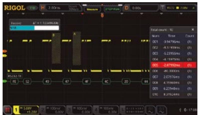
Figura 9. Disparo con la función de búsqueda y disparo de zona del RS-232 y grabación de los 18 fotogramas con 50 Mpts cada uno, incluyendo la decodificación del bus RS-232.
