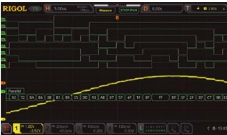
Figura 2. Salida del DAC y la entrada de 8 bits (en paralelo) del DAC, incluida la decodificación.
