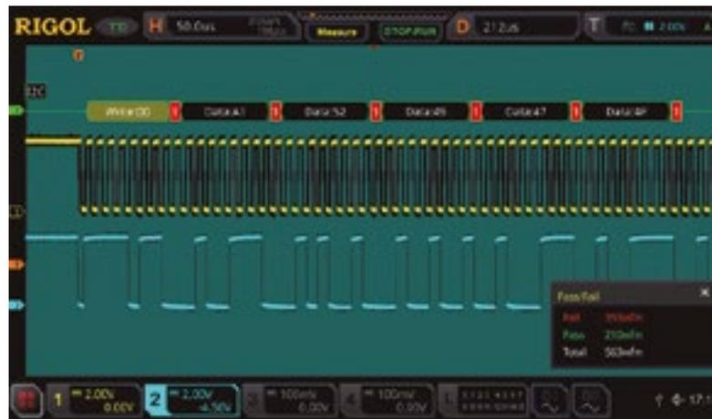
Figura 10. Uso de la máscara de pasa/falla en una señal de reloj de un bus I2C.
