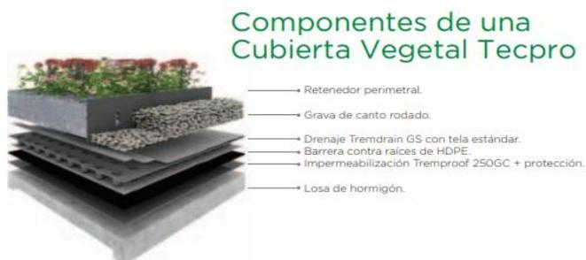
**Ilustración N°16:** Componentes de una Cubierta Vegetal
