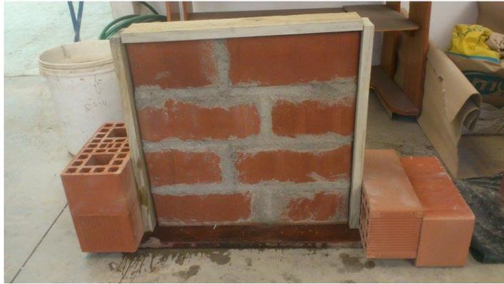
Figura 4.15: Moldaje Muro Albañilería
