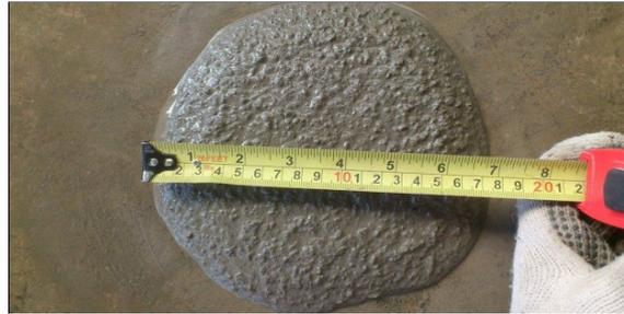
Figura 4.19: Ensayo consistencia de mortero      Figura 4.20: Muestra cono de la mesa de sacudida
