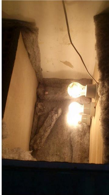
Figura: 4.44: Ensayo térmico muro de albañilería estucado con corcho reciclado
