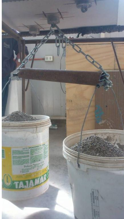
Figura 4.36: Extracción de pastillas por carga directa.
