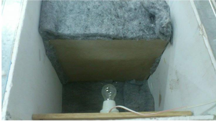
Figura 4.41: Ensayo térmico muro de albañilería
