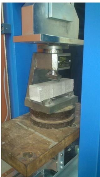
Figura 4.25: Probeta RILEM ensayo de Flexión
