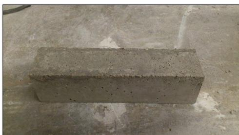
Figura 4.22: Probeta RILEM
