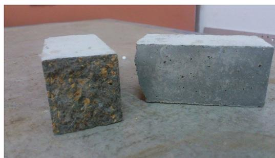
Figura: 4.26: Probeta sometida a flexión 70/30
