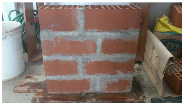
Figura 4.14: Muro de albañilería (50x50 cm)
