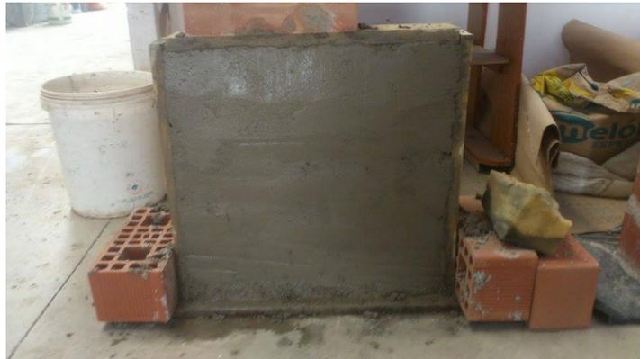
Figura 4.16: Muro revestido, mortero patrón
