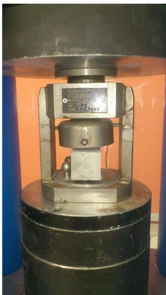
Figura 4.28: Probeta RILEMA en ensayo de Compresión
