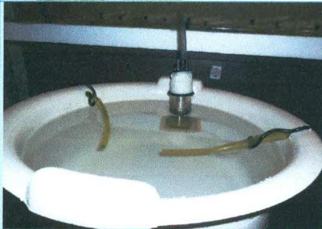
Figura 43. Recipiente con agua destilada, retornos y bomba.
