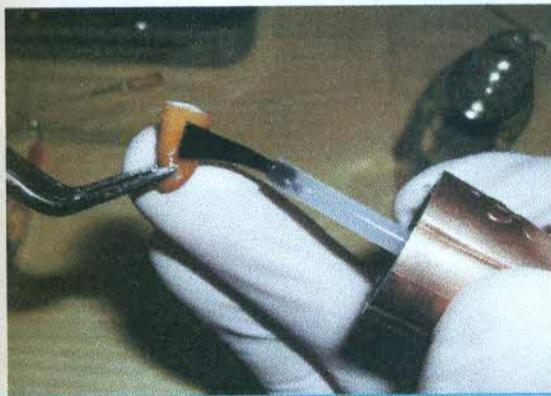
Figura 40. Aplicación de la capa de esmalte.
