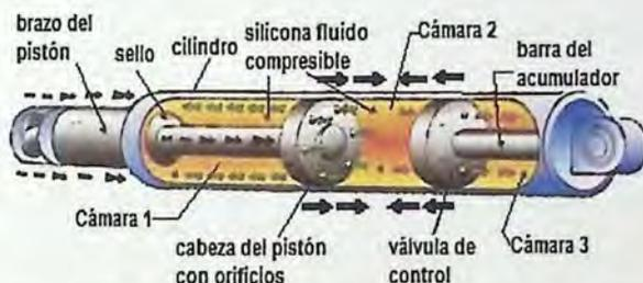
Figura 2.17 - Funcionamiento de un Disipador de Fluido Viscoso [19].
