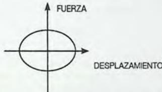
Figura 2.8 - Ciclo fuerza-deformación disipador activado por velocidad [6].
