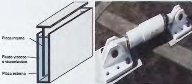
Figura 2.9 - Disipador muro viscoso y disipador fluido-viscoso respectivamente [6].
