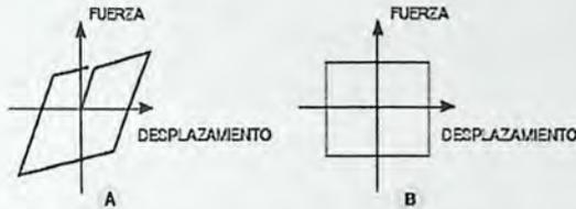
Figura 2.10 - Ciclo carga-deformación disipador activado por desplazamiento: a) Metálico, b) Friccional [6].
