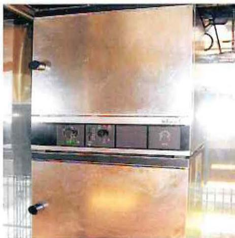
Figura 4.7: Polimerización en el horno a 37° C.
