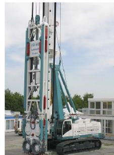
(a) Cuchara bivalva montada en grúa oruga. (b) Hidrofresa montada en grúa oruga.
