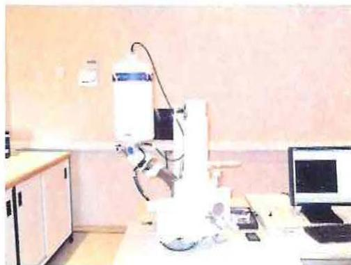
Figura 25. MEB marca JEOL, utilizado para observar las muestras
