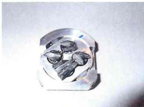
Figura 25 Soporte de las muestras metalizadas para ser llevadas al MEB
