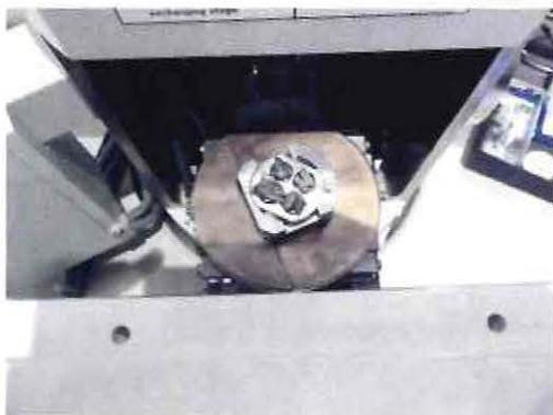
Figura 25. Foto del porta muestras que se posiciona dentro del MEB para realizar las observaciones
