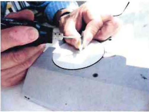
Figura 23. Procedimiento de estriado de las muestras.
