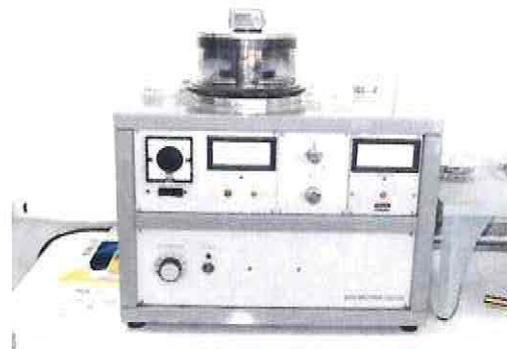
Figura 24B. Proceso de metalizado de las muestras
