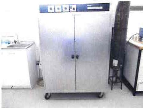
Figura 24A. Estufa de secado
