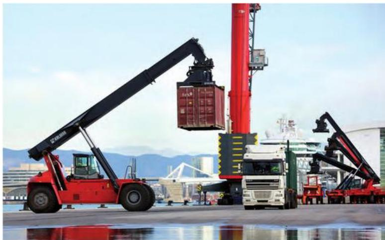
**Figura 2.13** Apilador frontal con bastidor de anclaje
