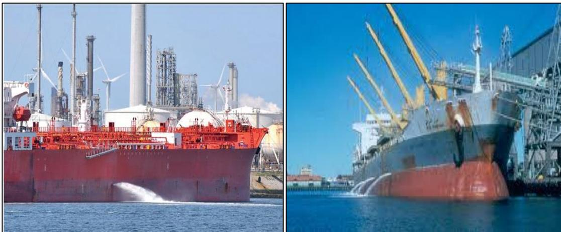
*Figura 4: Descarga de lastre en los Puertos durante las faenas de embarque. Fuente: Elaboración propia.*
