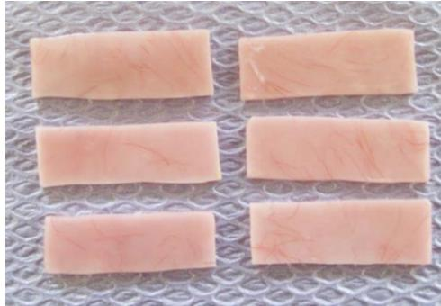
Figura 1: Muestras de resina acrílica de termopolimerización de 20x8x1 mm.
