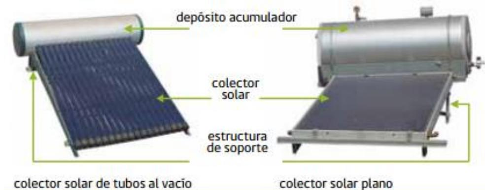
Ilustración 23 Partes de los colectores, en su forma básica.
