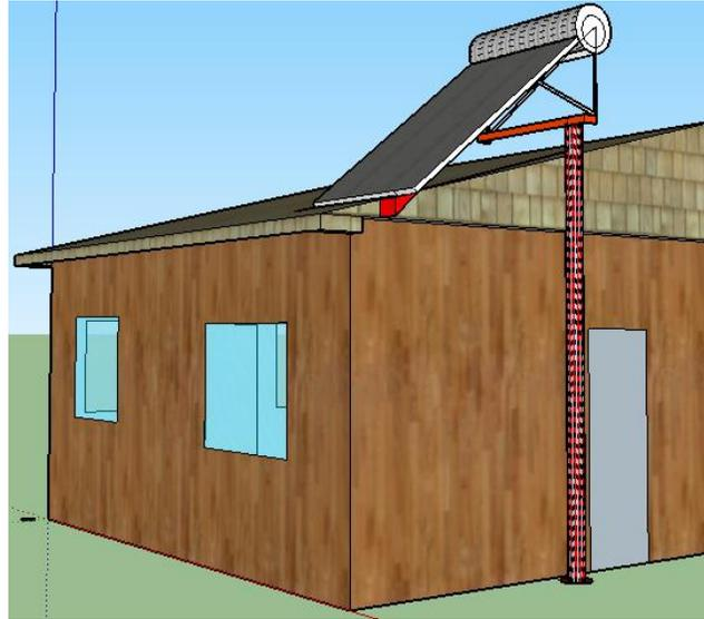
Ilustración 39 Simulación de vista inferior de SST con perfil de apoyo.
