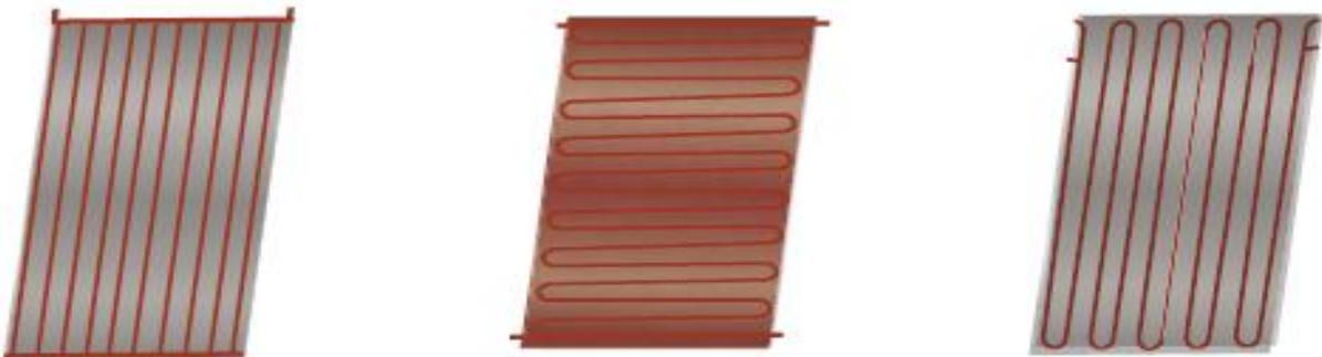
Ilustración 7 Diseños de absorbente en CST, placa plana
