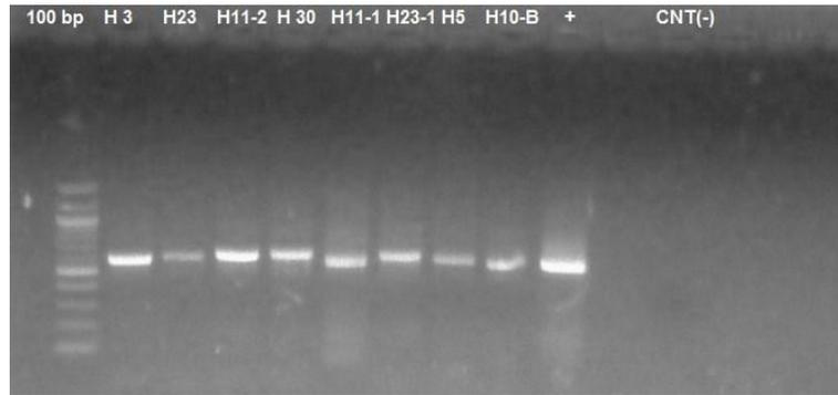
Figura 3.35: Presencia de ADN en las muestras trabajadas. En esta imagen se ven 9 muestras que están siendo analizadas por el transiluminador UV.
