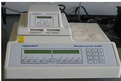
Figura 3.36: Termociclador. Aparato en el que se efectúa el PCR convencional
