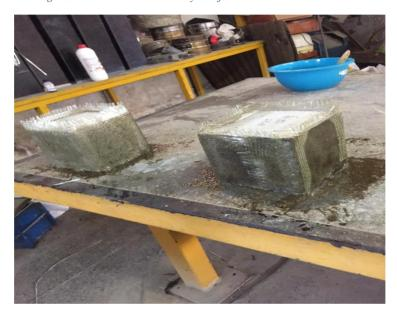
Figuras 3-9:Muestra de Resina y Confinamiento en Fibra de Vidrio
