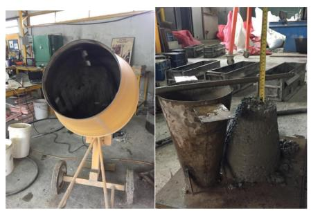
Figuras 3-5:Muestra de cono y betonera dependencias del laboratorio
