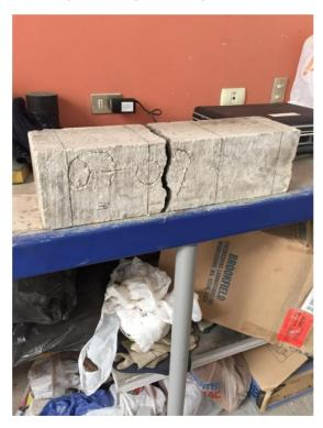
Figuras 5-1:Viga de Hormigon Fisurada
