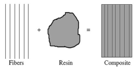
Figuras 2-2: Composición de un material Compuesto
