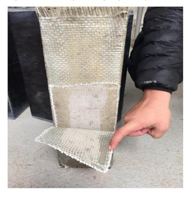
Figuras 5-3:Muestra de la falla en la viga confinada con fibra de Vidrio
