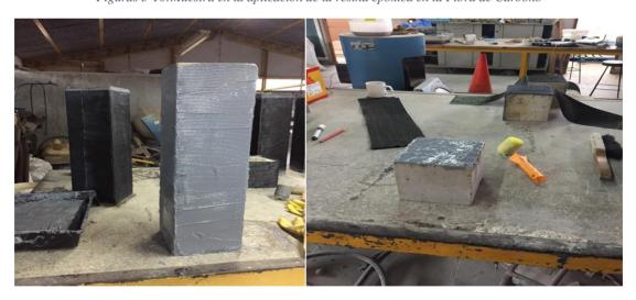
Figuras 3-10:Muestra en la aplicación de la resina epoxica en la Fibra de Carbono
