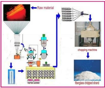
Figuras 2-4:Proceso de Fabricación Fibra de Vidrio
