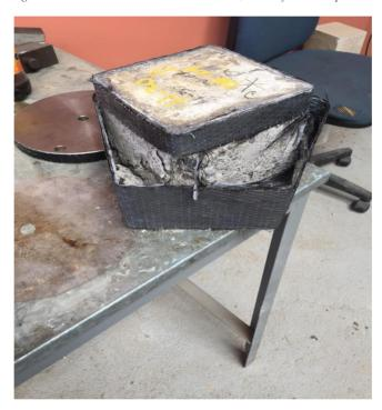
Figuras 5-2:Muestra de Probeta tras realizar ensayo de compresión
