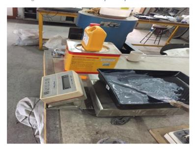
Figuras 3-8:Muestra de Resina epoxica aplicada al carbono
