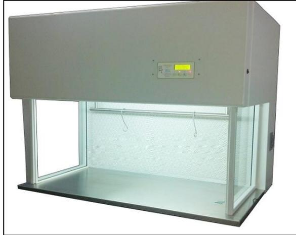
Figura 6.2.3 – Cámara de Flujo Laminar.
