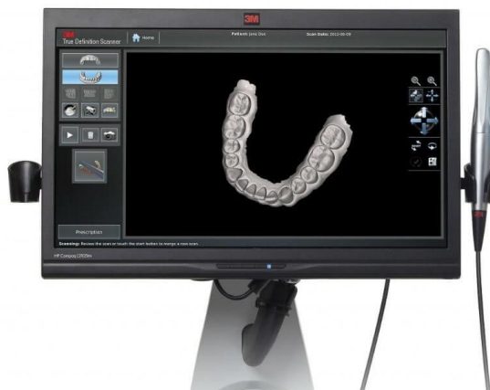
Figura 5: imagen referencial de modelo de superficie 3D creado por un software mediante el uso de escáneres intraorales.
