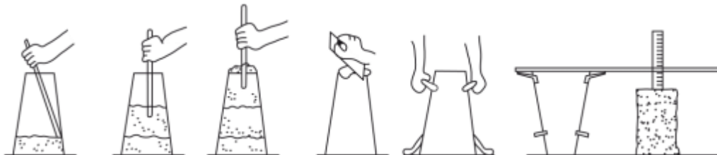
FIGURA 2.14: PROCEDIMIENTO CONO DE ABRAMS.
