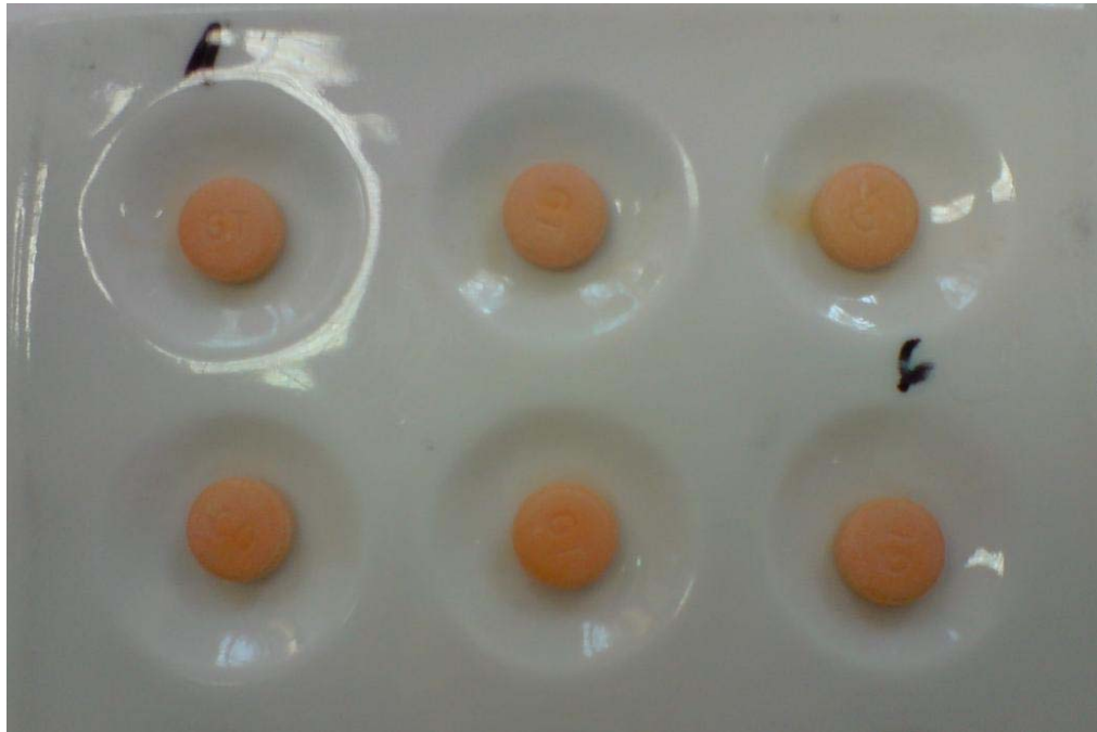
Figura N° 27: Comprimidos de diclofenaco sódico con recubrimiento entérico sometidos a una prueba de disolución con aparato 2 de la USP a 75 rpm, durante dos horas en medio buffer acetato pH 4,5.
