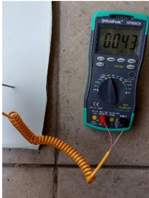
Figura 4.2: Medición de la temperatura de solidificación de la parafina.
