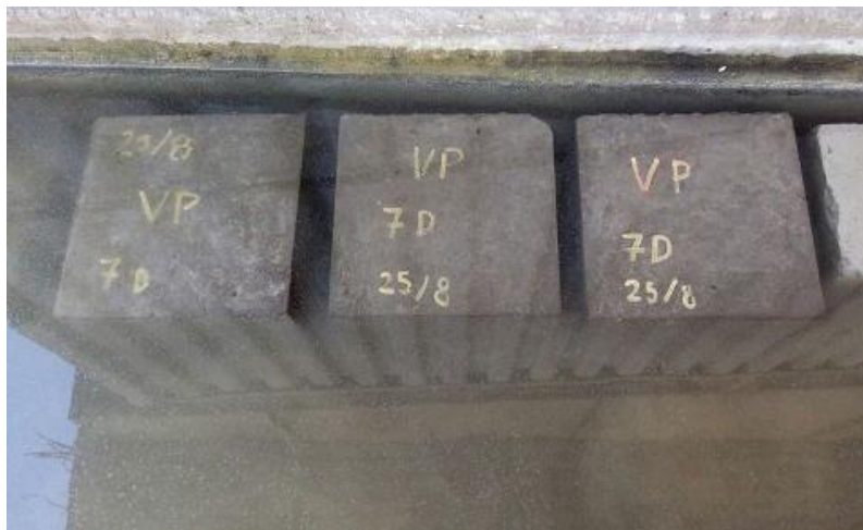
Figura 4.14: Probetas de prueba, con dosificación inicial. Fuente: Elaboración propia.
