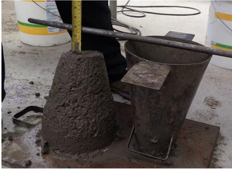
Figura 4.16: medición de asentamiento del cono de Abrams. Fuente: Elaboración propia.
