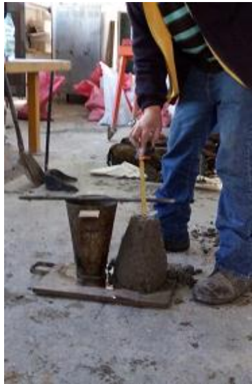
Figura 4.12, 4.13: Asentamiento del cono. Fuente: Elaboración propia.
