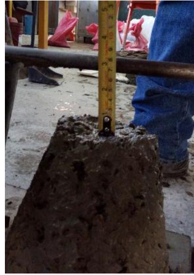
Figura 4.12, 4.13: Asentamiento del cono. Fuente: Elaboración propia.
