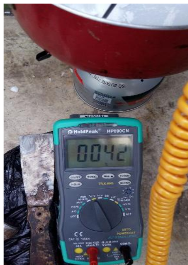
Figura 4.1: Medición de la temperatura de fusión de la parafina. Fuente: Elaboración propia.
