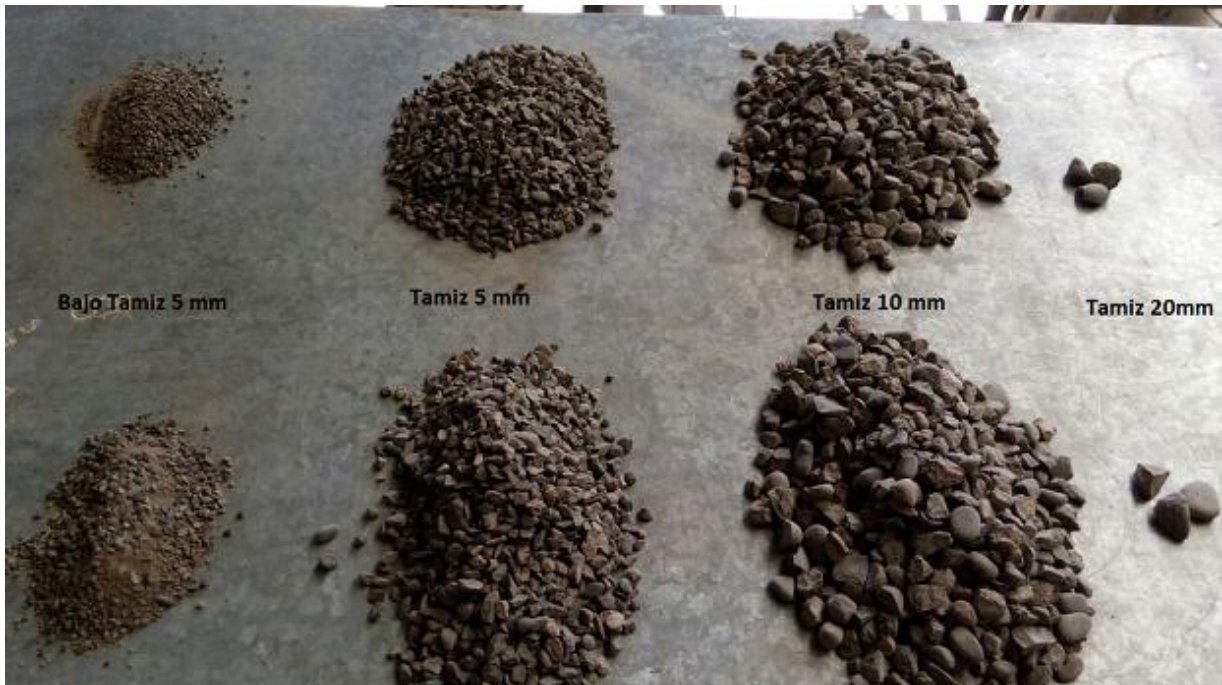
Figura 4.11: Tamizado de la grava. Fuente: Elaboración propia.
