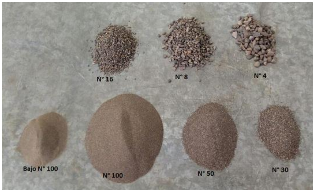
Figura 4.9: Tamizado de la arena.
