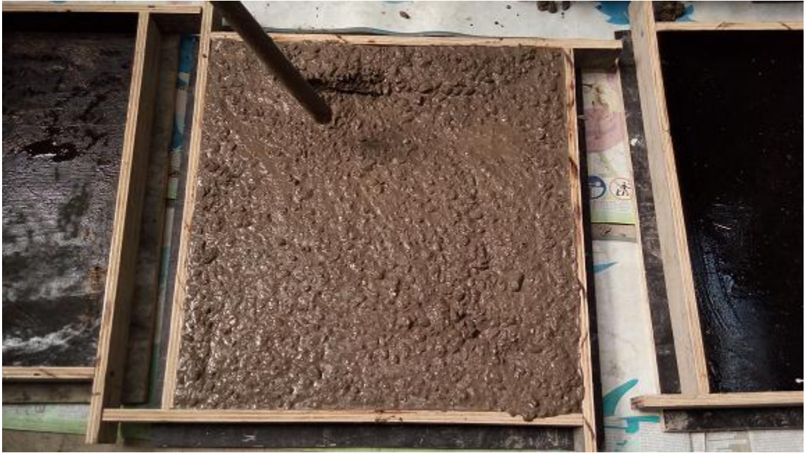
Figura 4.18: Vibrado de moldes. Fuente: Elaboración propia
