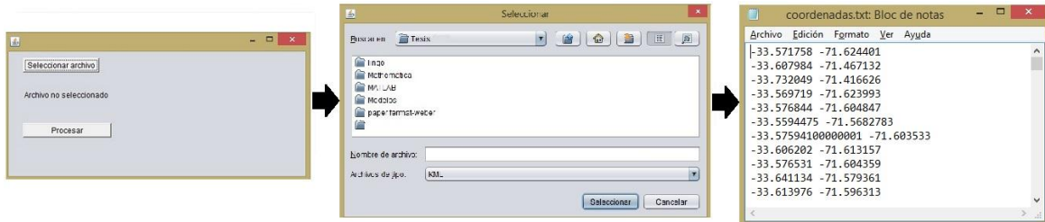
Figura 3.13: Extracción de coordenadas de archivo .kml mediante aplicación JAVA
