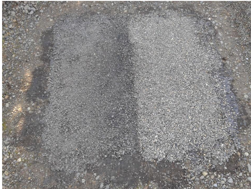
Figura 4.2 Cancha de prueba de tratamiento superficial simple, con árido de escoria a la izquierda y árido tradicional a la derecha.
