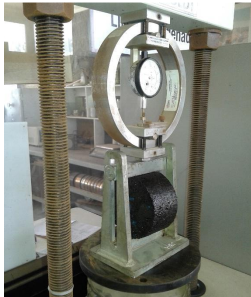
Figura 5.1 Probetas con 3% de contenido óptimo de asfalto, ensayadas a tracción indirecta (ITS).
