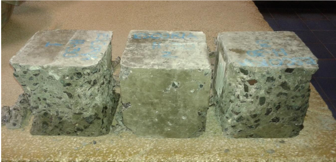
Figura 4.14 Probetas de hormigón con reemplazo de fracción gruesa por escoria de cobre, ensayadas a compresión.
