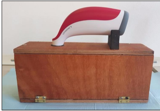
Figura 23: Se muestra el Vita Easyshade correctamente posicionado listo para medir.
