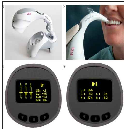
Figura 16: Vita easyshade compact a). Calibración del instrumento, b). Medición del color, c) Valores de la mediciones de color comparadas con su correspondiente en Vitapan Clasico, d) Correspondencia de los valores con Vitapan 3D- Master. 50
