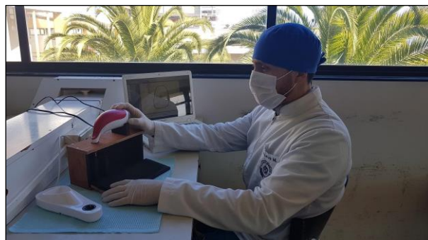
Figura 19: Posicionamiento del espectrofotómetro en la caja (abierta).
