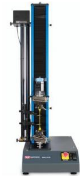
Figura I. Máquina de ensayos universal INSTRON, EMIC 23 5S.
