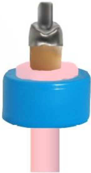
Figura II. Cuerpo de prueba con aditamentos para traccionar.
