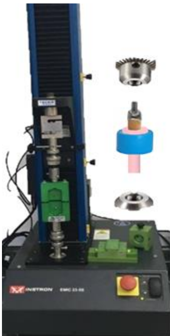
Figura II. Tracción de cuerpos de prueba.
