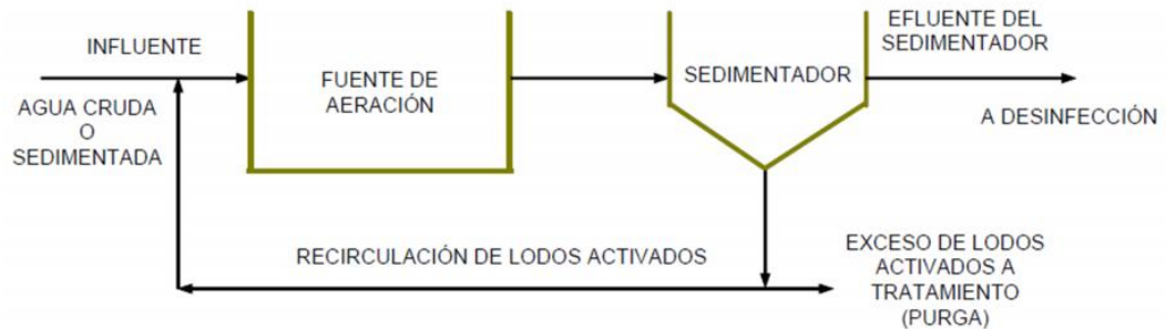
FIGURA 9. Proceso básico de lodos activados
