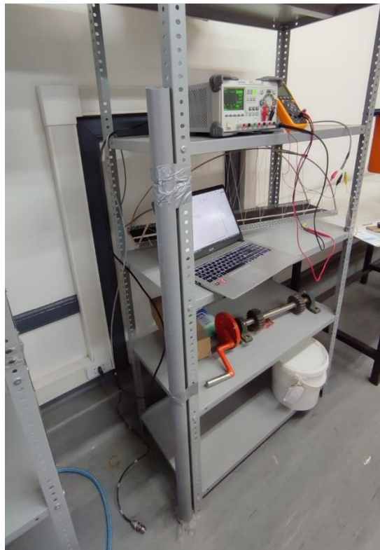
Figura 5.4: Prueba de funcionamiento de sensor de presión de agua y extensión del cable.
