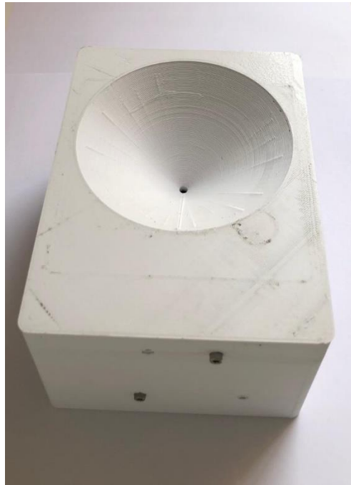
Figura 5.15: Caja impermeable con pluviómetro integrado
