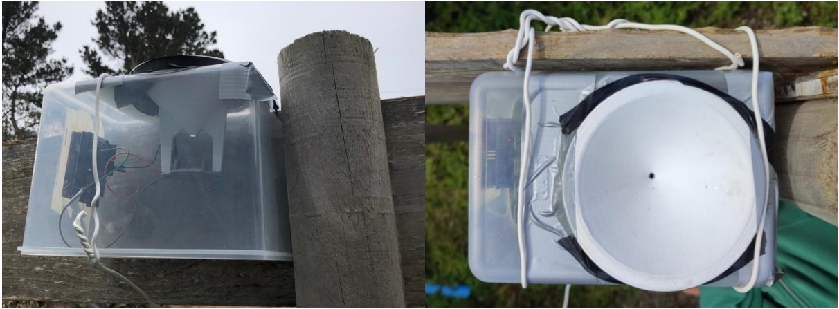
Figura 5.13: Pluviómetro instalado en oficinas SSR Quintay
