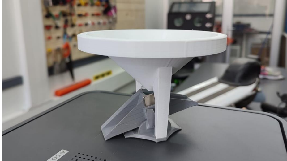
Figura 5.11: Pluviómetro impreso en 3D
