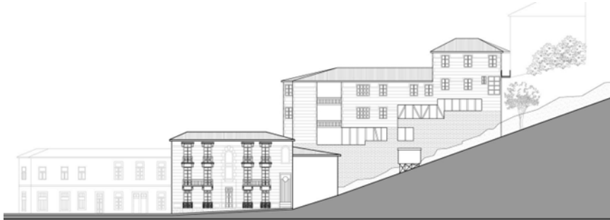
(71) Vista desde la calle Murillo hacia el ascensor Florida, donde el ascensor muestra una pendiente de 19 grados y un desnivel de 45 metros.
