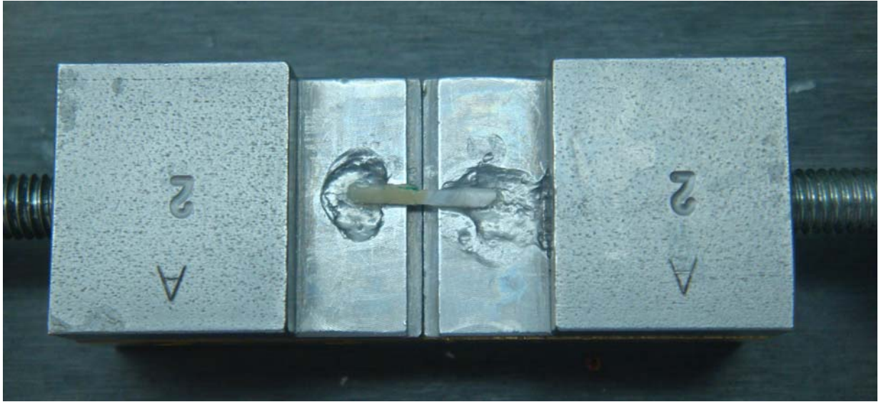
Figura nº 22: Varilla posicionada previa tracción
