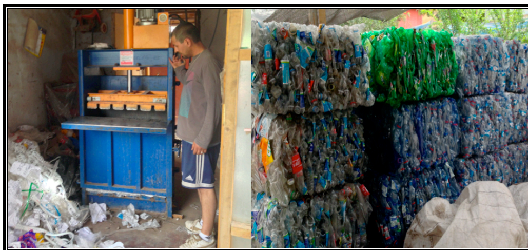
Figura 18: Fotografía de máquina compactadora y fardos resultantes en empresa R-limpia
