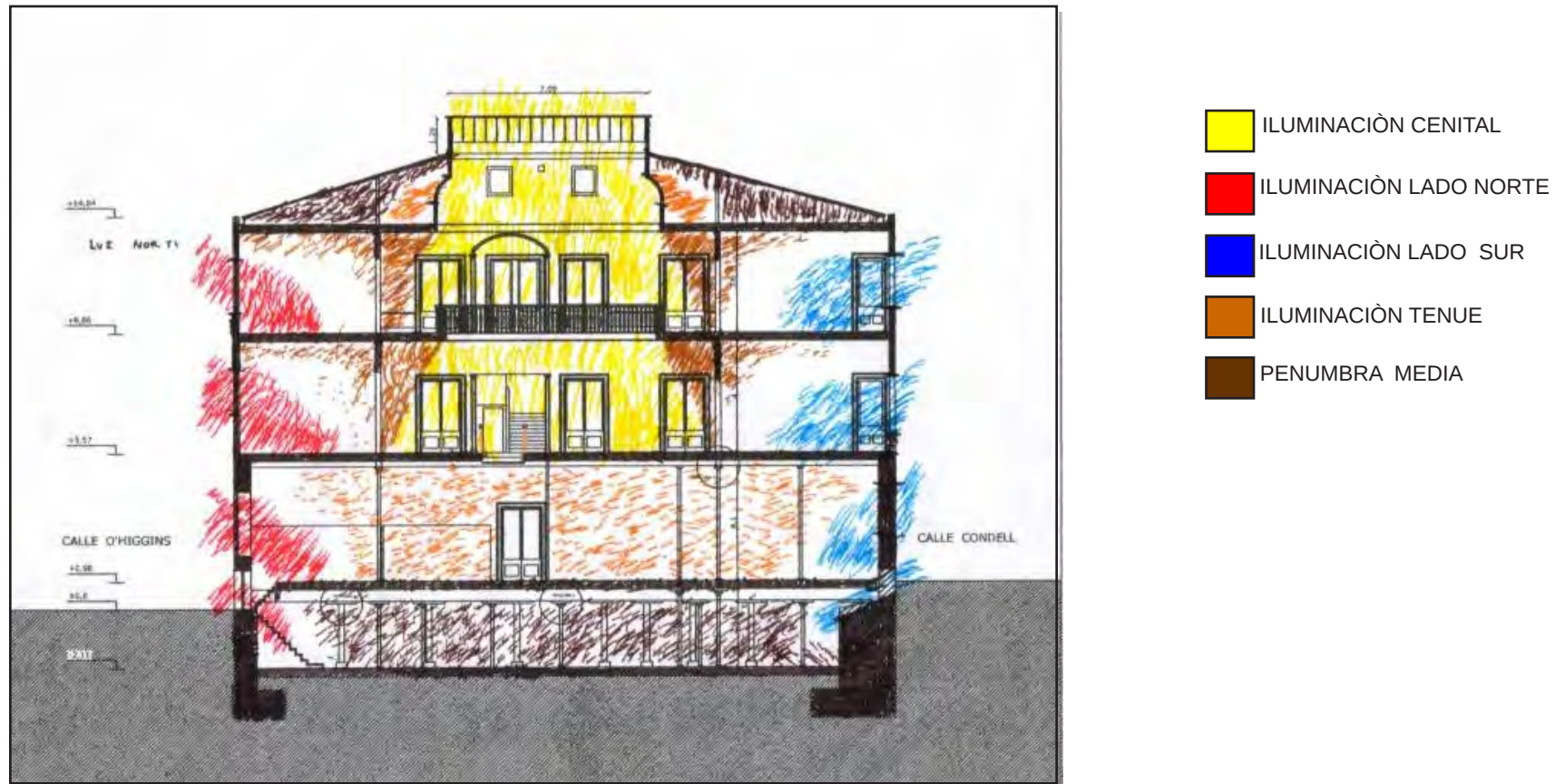
FIGURA N° 13 Esquema sobre iluminacion en el espacio interior.
