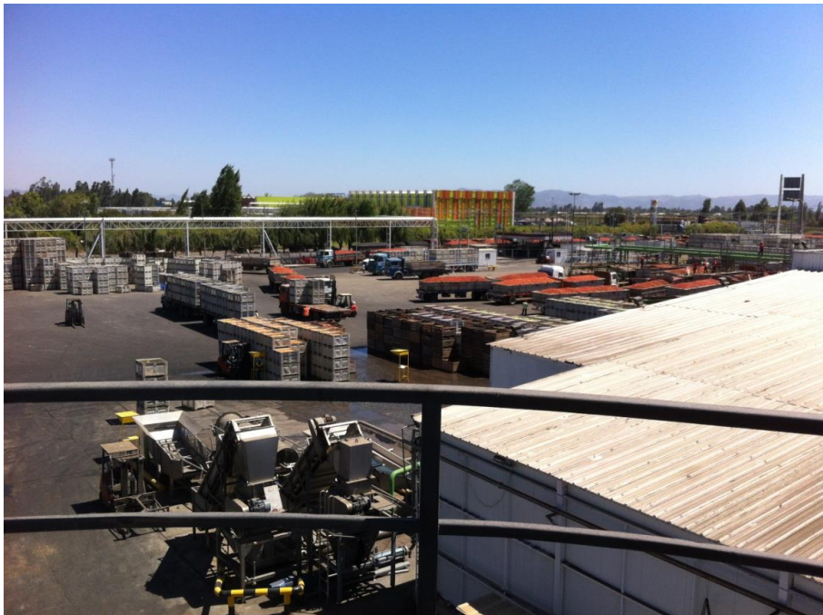
Imagen 13: Ingreso de materia prima a las líneas del proceso a través de volteadores. Fuente: Elaboración propia.
