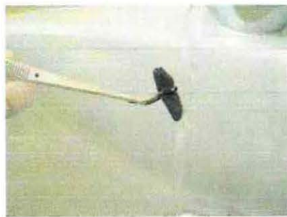
Fig 13 y 14. Muestras inmersas en tinta para su filtración, una vez pasado el tiempo estipulado, lavado con abundante agua
