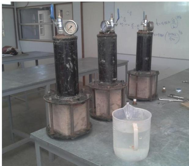
**Figura 4.17 – Probetas en equipo para ensaye de permeabilidad.**
