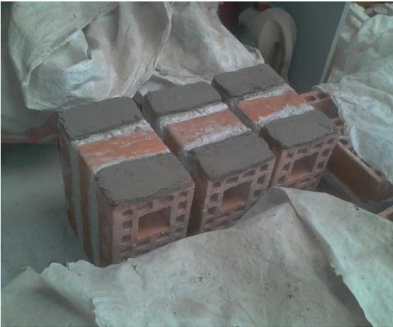
**Figura 4.25 – Refrentado de los ladrillos laterales.**
