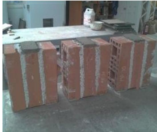
**Figura 4.26 – Refrentado de los ladrillos centrales.**
