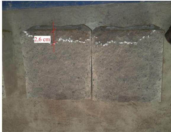
**Figura 4.18 – Penetración de agua en probeta con aditivo 1:12.**
