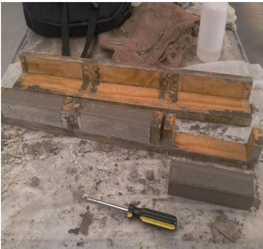
**Figura 4.8 - Desmoldado de probetas.**
