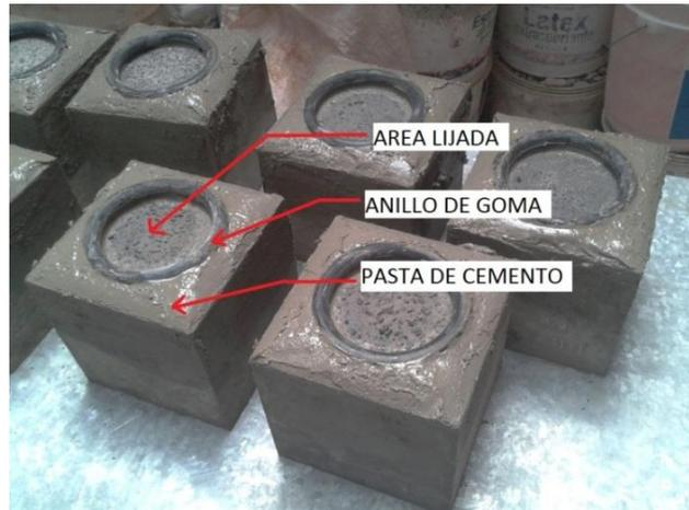
**Figura 4.16 – Probetas lijadas, con el anillo y la pasta de sellado.**
