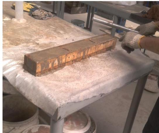
**Figura 4.6 - Vibrado del mortero.**
