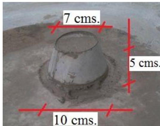
**Figura 4.2 – Mortero con el molde troncónico sobre mesa de sacudidas.**
