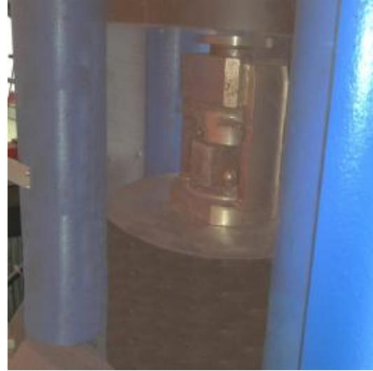
**Figura 4.10 – Equipo para ensaye a compresión.**
