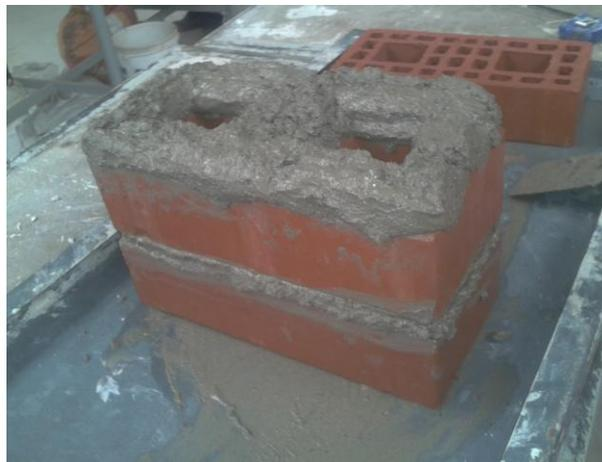
**Figura 4.23 – Unión primeros dos ladrillos.**
