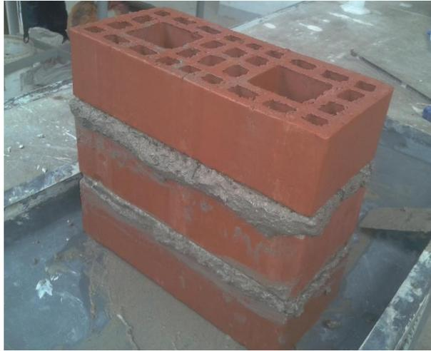
**Figura 4.24 – Unión de los 3 ladrillos.**
