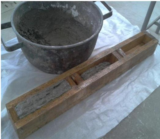
**Figura 4.5 - Llenado de molde para ensaye de resistencia mecánica.**
