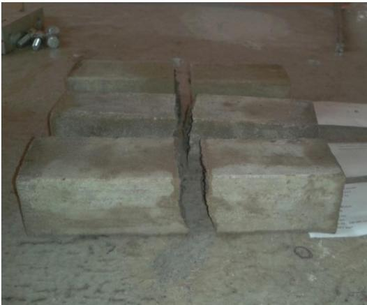
**Figura 4.12 – Probetas después de ensaye a flexión.**
