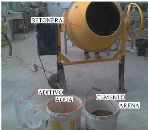
**Figura 4.13 - Materiales y betonera para confeccionar el mortero.**
