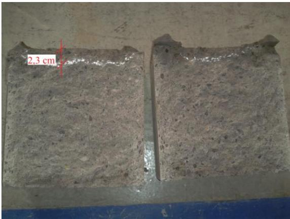
**Figura 4.21 – Penetración de agua en probeta con aditivo 1:10.**
