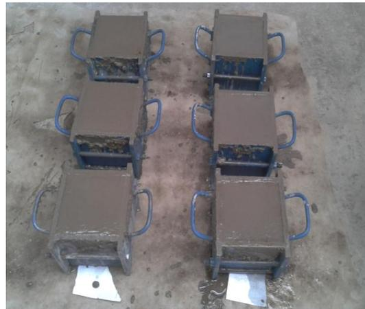
**Figura 4.14 - Mortero en los moldes para ensaye de permeabilidad.**
