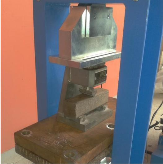
**Figura 4.9 – Equipo para ensaye a flexión.**
