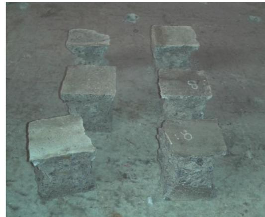
**Figura 4.11 – Probetas luego del ensaye a compresión.**
