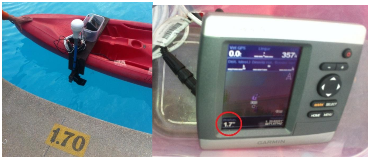
Figura 34: Prueba de funcionamiento de equipo monohaz en piscina con profundidad conocida.
