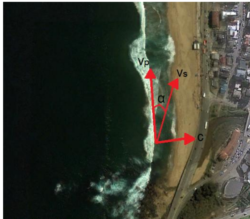
Figura 27: Ángulo Descrestamiento ( V_p : velocidad de descrestamiento; V_s : Velocidad de línea descendente; C: Celeridad de onda)
