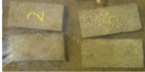
Figura 5.2. Inmersión total de los ladrillos elaborados.
