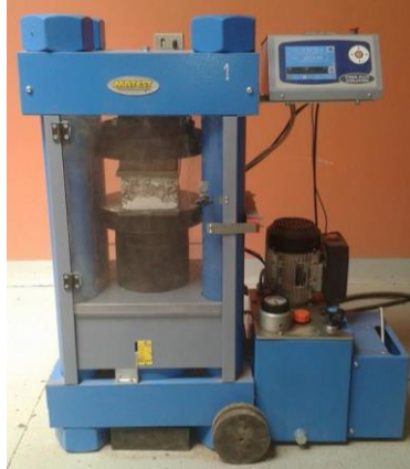
Figura 5.5. Ladrillo elaborado en máquina de ensayo.
