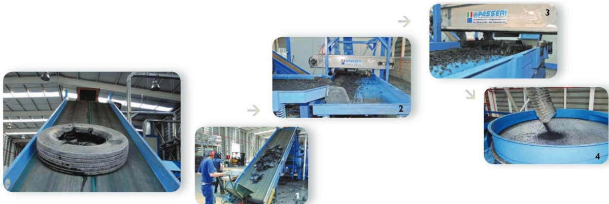
Figura 2.10. Proceso de trituración NFU.
