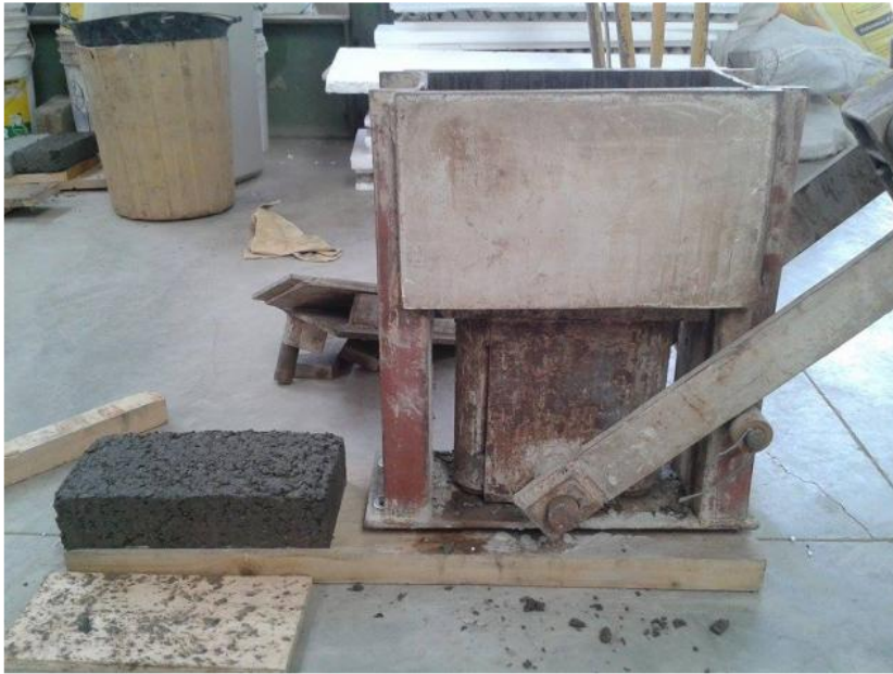
Figura 4.11. Máquina compactadora y ladrillo.
