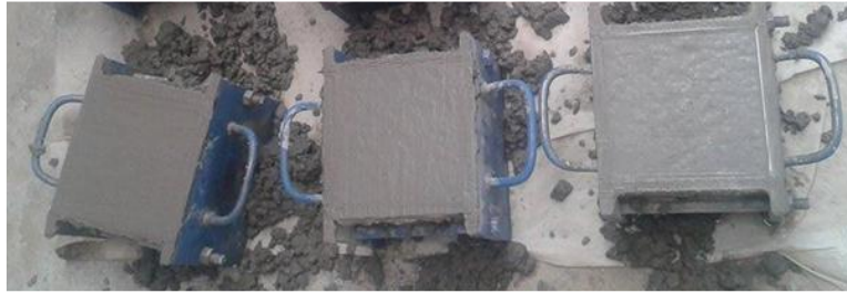
Figura 4.4. Llenado de probetas.
