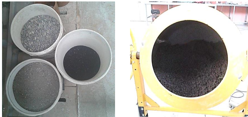
Figura 4.9. Dosis de grava, arena y caucho y elaboración de hormigón en betonera.
