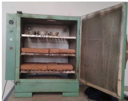
Figura 5.1. Secado en horno ladrillos cerámicos.
