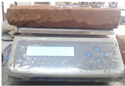
Figura 5.3. Ladrillo artesanal luego de la inmersión.
