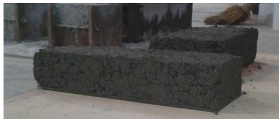
Figura 4.12. Ladrillos elaborados con un 20% de caucho.
