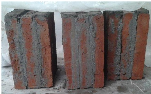
Figura 5.7. Probetas para ensayo de adherencia ladrillo artesanal.
