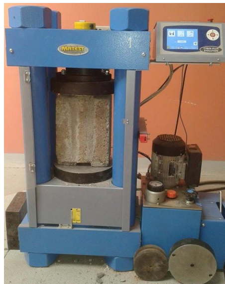
Figura 5.9. Ensayo de adherencia a ladrillo elaborado.
