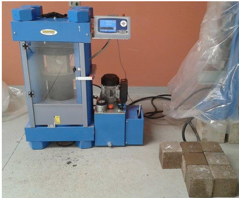
Figura 4.6. Máquina para ensayo de compresión.
