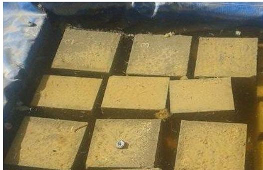
Figura 4.5. Probetas en la piscina de curado.
