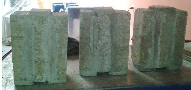
Figura 5.8. Probetas para ensayo de adherencia ladrillo elaborado.
