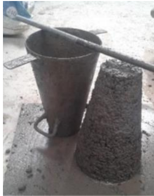
Figura 4.3. Ensayo Cono de Abrams.
