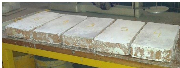
Figura 5.4. Ladrillo artesanal con caras de carga refrentadas.
