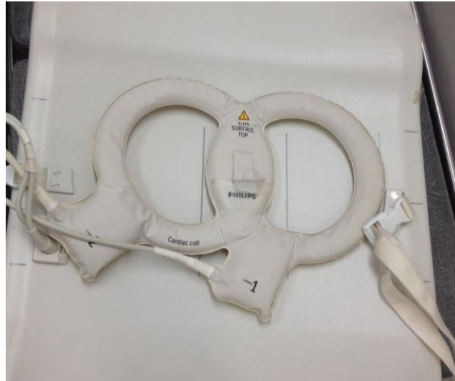
FIGURA 10.1 Bobina cardíaca de 5 canales utilizada en el resonador marca Philips Intera 1.5T para la realización de las resonancias magnéticas prostáticas en el Hospital Naval Almirante Nef.
