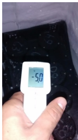
Figura 4-4: Control de temperatura a la simulación ciclo hielo-deshielo
