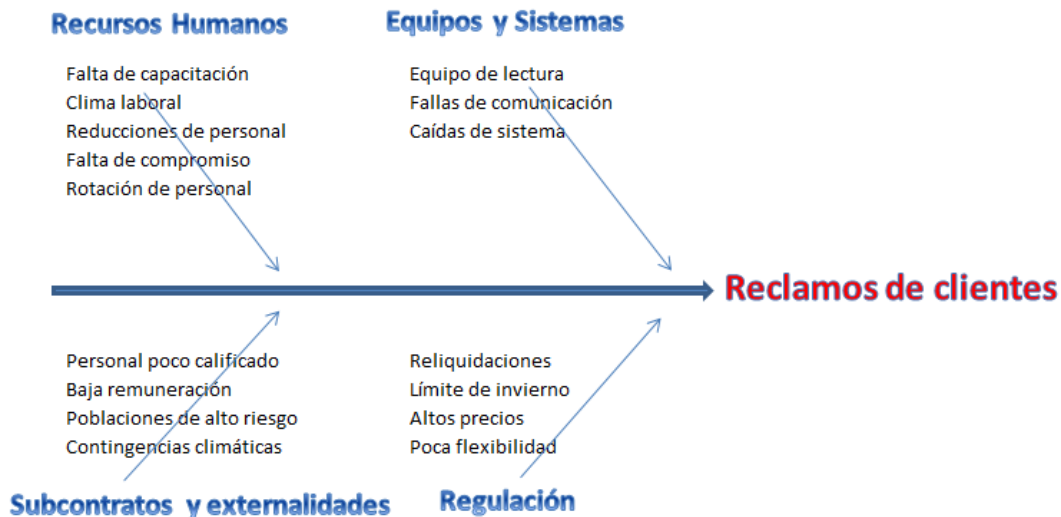
Figura N°20 – Diagrama Causa-Efecto para los reclamos recibidos por empresas de distribución de energía eléctrica.
