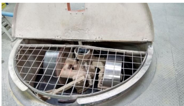
Figura 2.5 Mezcladora para la homogenización de Polvos-Agua-Silicato de sodio.
