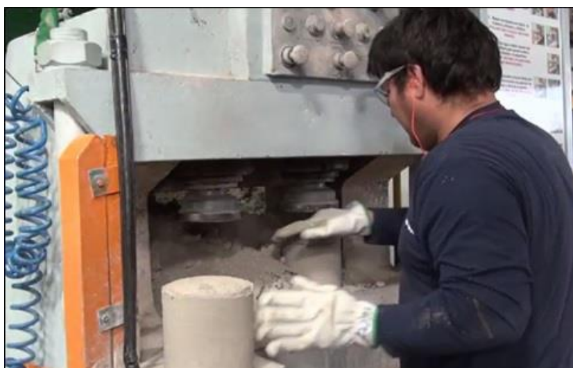
Figura 2.6 Formación de panes de revestimiento.
