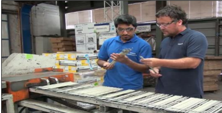
Figura 2.15 Retiro de muestras para pruebas mecánicas.
