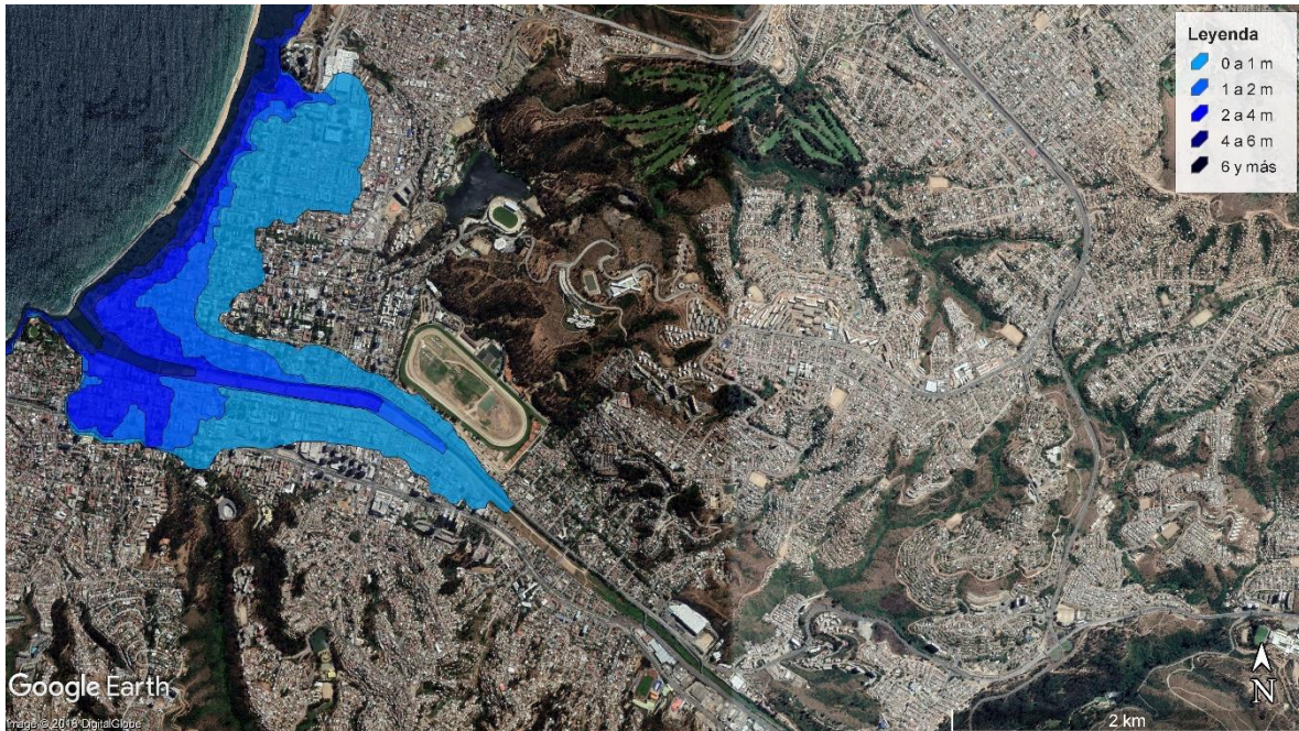
Figura 29: Máxima profundidad de flujo del escenario 4.
