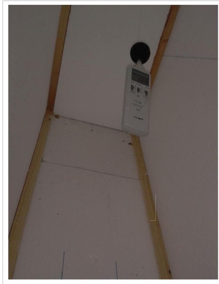
Figura 4.6.- Sonómetro en registro de mediciones.
