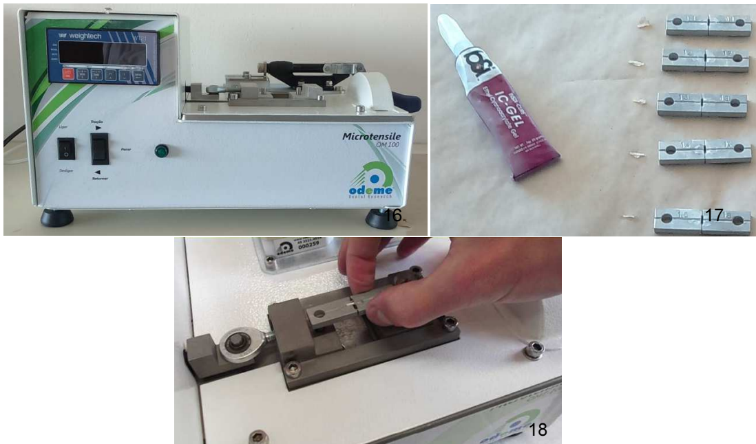
Fig. 16 Máquina Microtensile OM 100; Fig. 17 Fijación de varillas al dispositivo para \mu TBS; Fig. 18 Montaje de dispositivo
